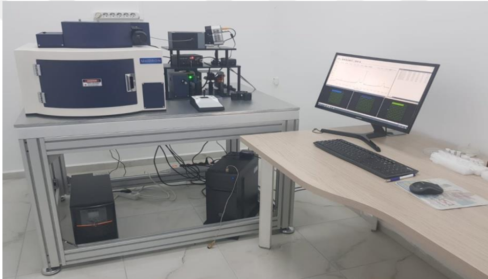
Şekil 4.25 : Laboratuvarımızda bulunan 532 nm'lik UniDRON marka Raman spektroskopisi cihazı.
