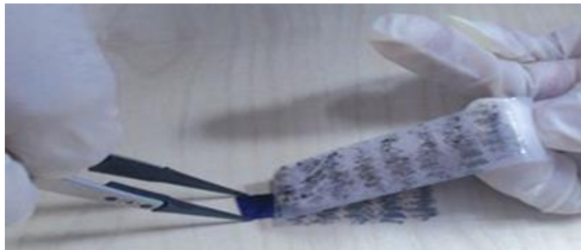
Şekil 2.11 : Grafenin selobant ile soyulması [2].
