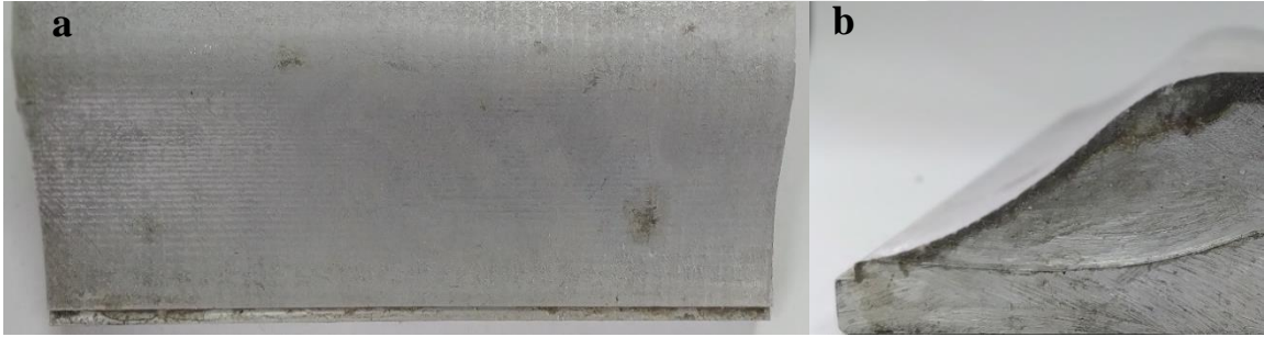
Şekil 4.2: Kompozit malzemenin üretimi için kullanılan kalıp (a) kalıbın üst görünümü (b) kalıbın yan görünümü.
