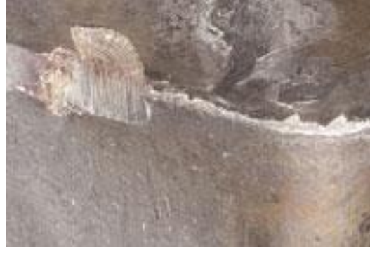
Şekil 3.12: Kesici takımında oluşan BUE aşınması [61].
