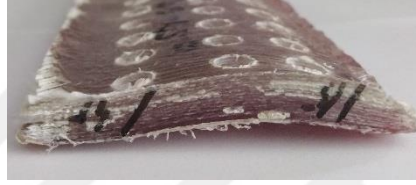
Şekil 4.4: Deneyde kullanılan cam elyaf takviyeli serbest şekilli yüzey formuna sahip kompozit malzeme.
