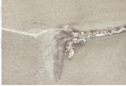
Şekil 3.11: Kesici takımında oluşan çentik aşınması [61].
