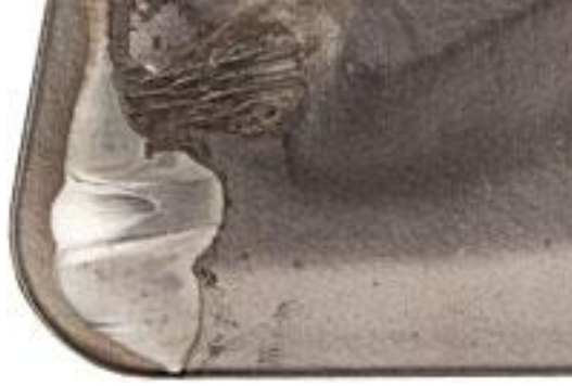
Şekil 3.10: Kesici takımında oluşan krater aşınması [61].
