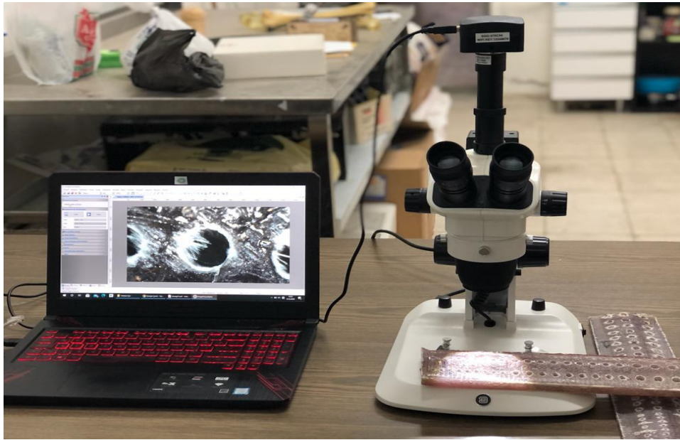
Şekil 4.6: Delaminasyon ölçüm düzeneği.
