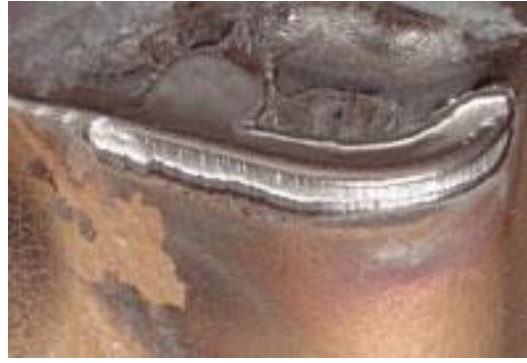
Şekil 3.9: Kesici takımında oluşan serbest yüzey aşınması [61].
