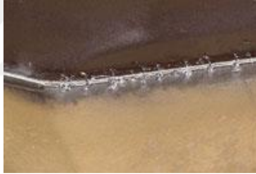
Şekil 3.13: Kesici takımında oluşan Çatlak aşınması [61].
