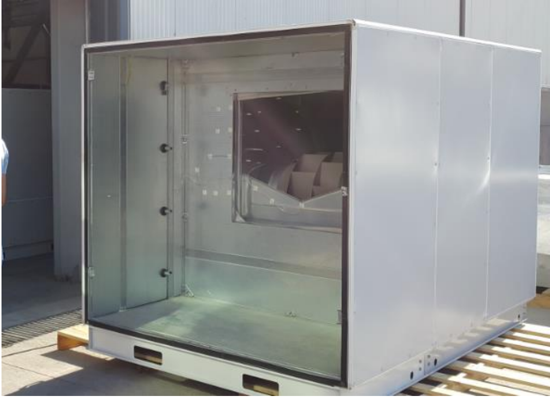
Şekil 4.2 Difüzörü sökülmüş boş hücre
