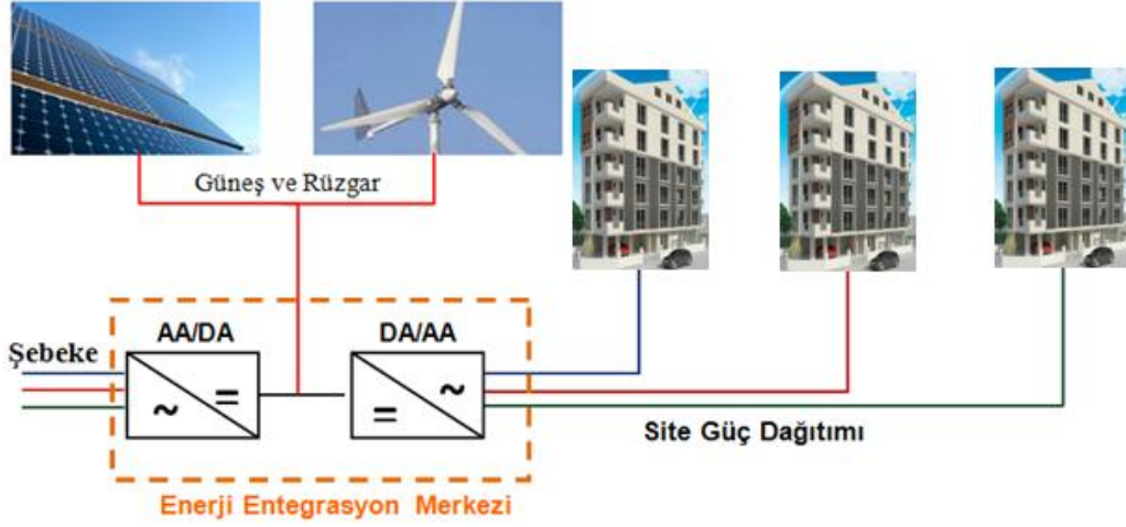
Şekil 5.16. Melez mikro şebekeye sahip sitenin güç dağıtım şebekesi
