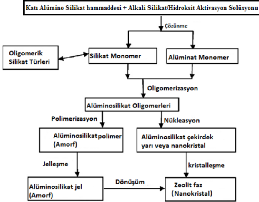
Şekil 5. Geopolimerizasyonun reaksiyon aşamaları
