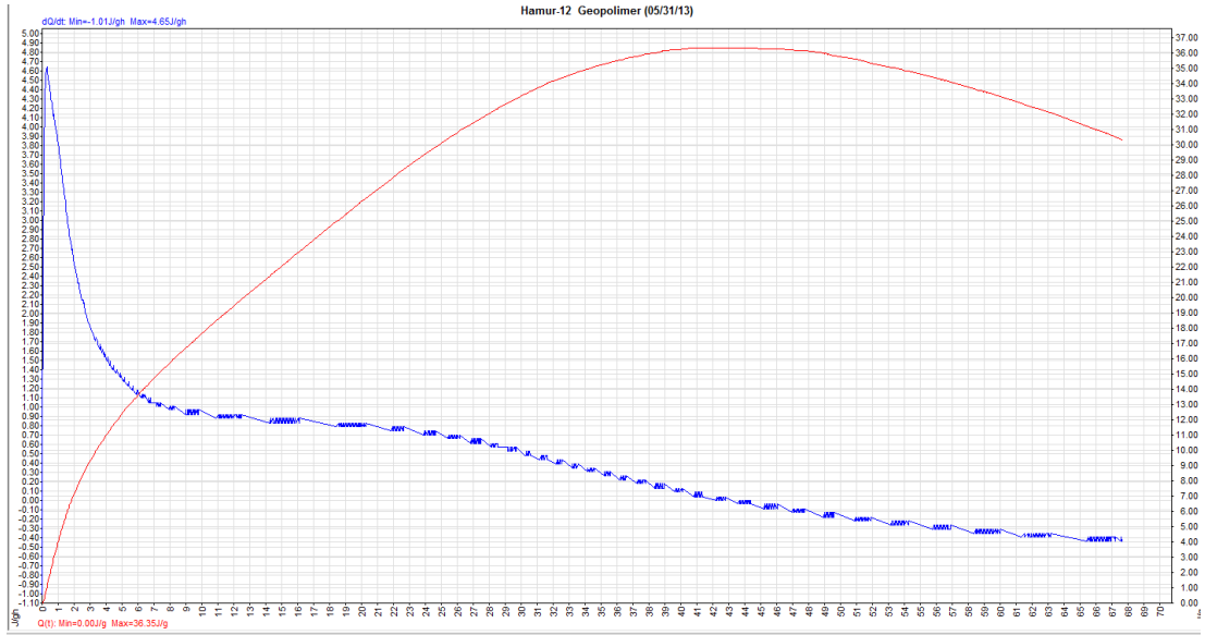
Şekil 25. 12 nolu geopolimer hamur numunesinin zamana bağlı hidrasyon ısısı
