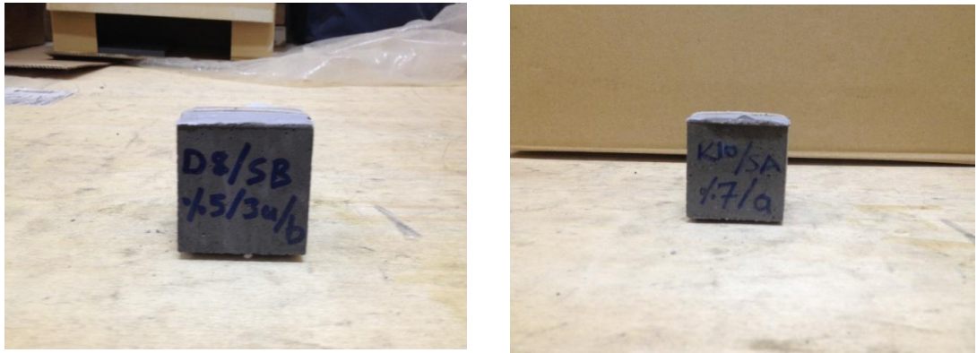
Şekil 44. 90 gün magnezyum sülfat çözeltisine maruz bırakılan beton numuneler
