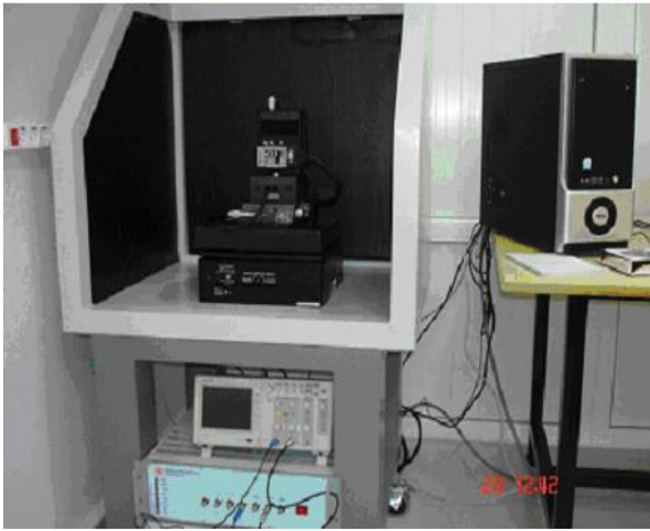
Şekil 3.11. a) Laboratuvarımızda kullanılan AFM sistemi b) AFM ucuna lazerle kuvvet uygulanması [43].
