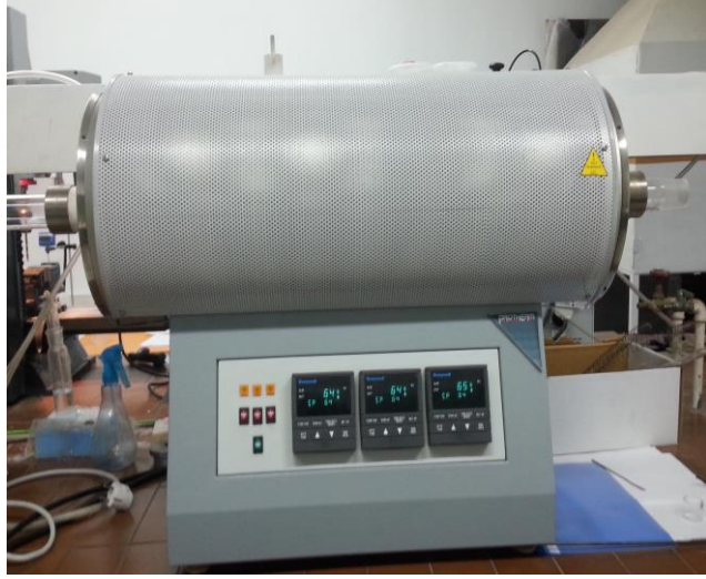
Şekil 3.4 Isıl işlemi için kullanılan programlanabilir tüp fırının resmi.
