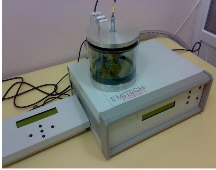
Şekil 3.3 Emitech K550X marka kaplama cihazının resmi.
