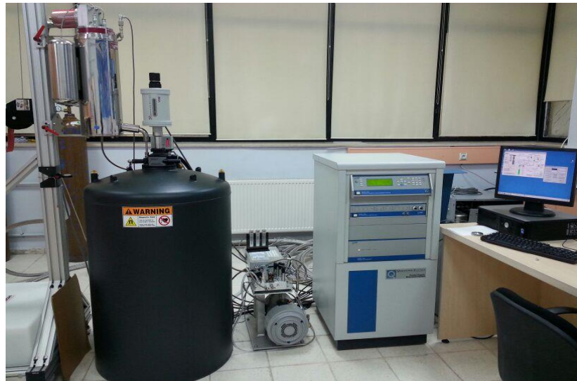
Şekil 3.10 M-H ölçümü için kullanılan VSM sisteminin fotoğrafı.
