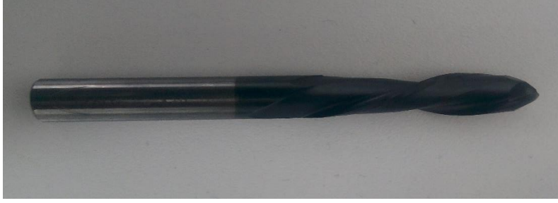
Şekil 3.13. Ara Kaba işlemede kullanılan 10 mm çaplı takım
