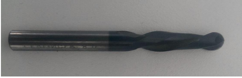
Şekil 3.13. Ara Kaba işlemede kullanılan 10 mm çaplı takım
