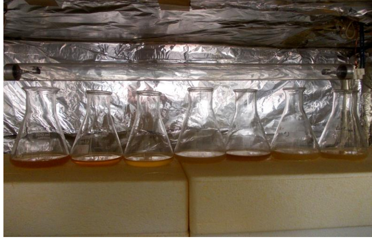
Şekil 3.3. Bakterilerin UV-C radyasyona maruz bırakılması
