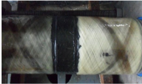
Şekil 4.40. DP 490 yapıştırıcı ile 40 mm yama kullanılarak yapıştırılan 55^{\circ}/-55^{\circ}/55^{\circ}/-55^{\circ} oryantasyon açılı tabakalı kompozit boruların hasar durumları
