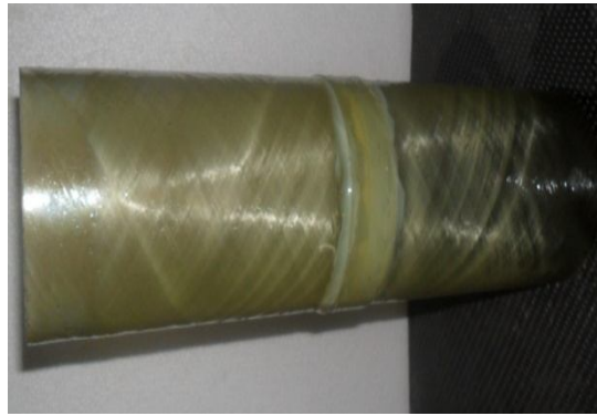
Şekil 4.37. DP 410 yapıştırıcı ile 30 mm yama kullanılarak yapıştırılan 55^{\circ}/-55^{\circ}/55^{\circ}/-55^{\circ} oryantasyon açılı tabakalı kompozit boruların hasar durumları
