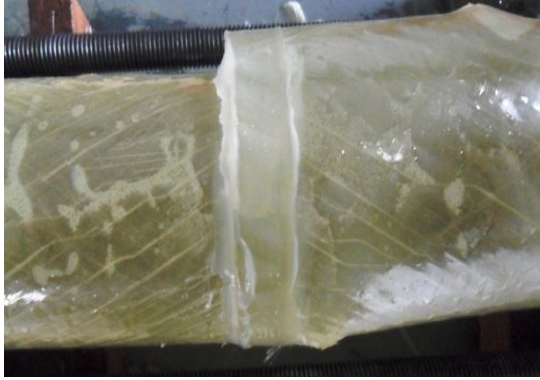
Şekil 4.51. DP 410 yapıştırıcı ile 20 mm bindirme uzunluğunda kademeli olarak yapıştırılan 55^0/-55^0/30^0/-30^0 oryantasyon açılı tabakalı kompozit boruların hasar durumları
