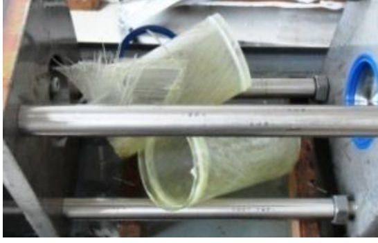
Şekil 4.29. DP 410 yapıştırıcı ile 20 mm yama kullanarak yapıştırılan 55^{\circ}/-55^{\circ}/30^{\circ}/-30^{\circ} oryantasyon açılı tabakalı kompozit boruların hasar durumları
