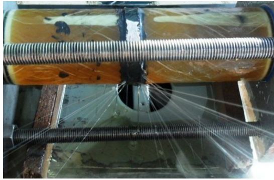
Şekil 4.30. DP 490 yapıştırıcı ile 20 mm yama kullanarak yapıştırılan 55^{\circ}/-55^{\circ}/30^{\circ}/-30^{\circ} oryantasyon açılı tabakalı kompozit boruların hasar durumları
