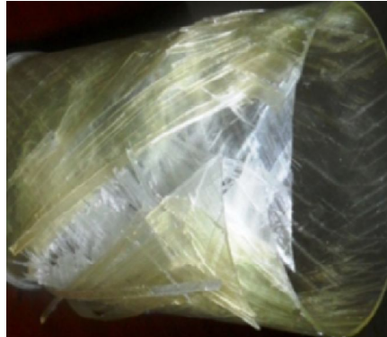
Şekil 4.31. DP 410 yapıştırıcı ile 30 mm yama kullanarak yapıştırılan 55^{\circ}/-55^{\circ}/30^{\circ}/-30^{\circ} oryantasyon açılı tabakalı kompozit boruların hasar durumları
