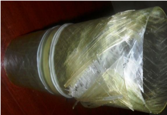
Şekil 4.31. DP 410 yapıştırıcı ile 30 mm yama kullanarak yapıştırılan 55^{\circ}/-55^{\circ}/30^{\circ}/-30^{\circ} oryantasyon açılı tabakalı kompozit boruların hasar durumları
