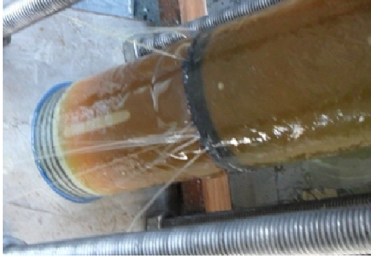
Şekil 4.48. DP 490 yapıştırıcı ile 10 mm bindirme uzunluğunda kademeli olarak yapıştırılan 55^{\circ}/-55^{\circ}/30^{\circ}/-30^{\circ} oryantasyon açılı tabakalı kompozit boruların hasar durumları
