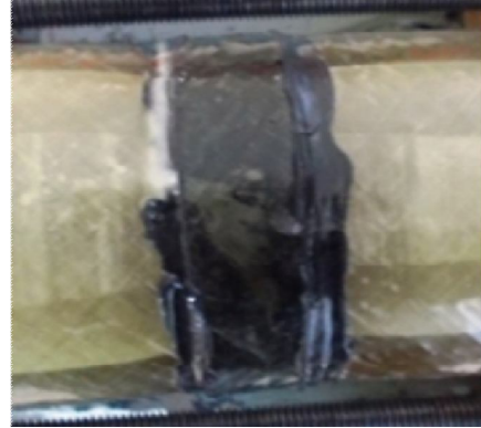
Şekil 4.26. DP 490 yapıştırıcı ile 30 mm yama kullanılarak yapıştırılan 45^{\circ}/-45^{\circ}/45^{\circ}/-45^{\circ} oryantasyon açılı tabakalı kompozit boruların hasar durumları
