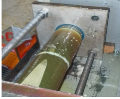
Şekil 4.17. DP 410 yapıştırıcı ile alın altına birleştirilmiş 45^{\circ}/-45^{\circ}/45^{\circ}/-45^{\circ} oryantasyon açılı tabakalı kompozit boruların hasar durumları
