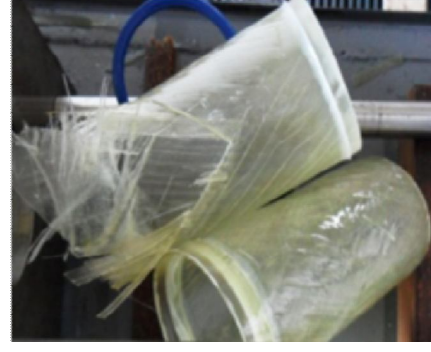
Şekil 4.29. DP 410 yapıştırıcı ile 20 mm yama kullanarak yapıştırılan 55^{\circ}/-55^{\circ}/30^{\circ}/-30^{\circ} oryantasyon açılı tabakalı kompozit boruların hasar durumları
