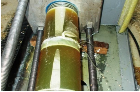
Şekil 4.45. DP 410 yapıştırıcı ile 20 mm bindirme uzunluğunda kademeli olarak yapıştırılan 45^0/-45^0/45^0/-45^0 oryantasyon açılı tabakalı kompozit boruların hasar durumları
