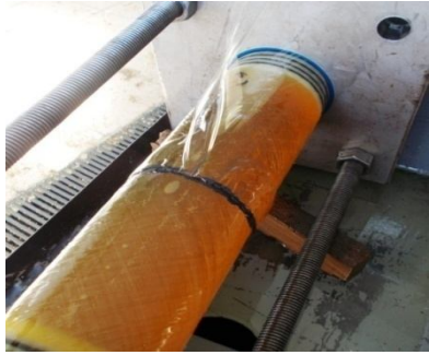
Şekil 4.18. DP 490 yapıştırıcı ile alın altına birleştirilmiş 45^{\circ}/-45^{\circ}/45^{\circ}/-45^{\circ} oryantasyon açılı tabakalı kompozit boruların hasar durumları
