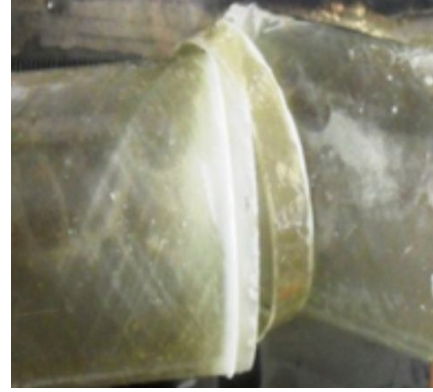
Şekil 4.35. DP 410 yapıştırıcı ile 20 mm yama kullanılarak yapıştırılan 55^{\circ}/-55^{\circ}/55^{\circ}/-55^{\circ} oryantasyon açılı tabakalı kompozit boruların hasar durumları
