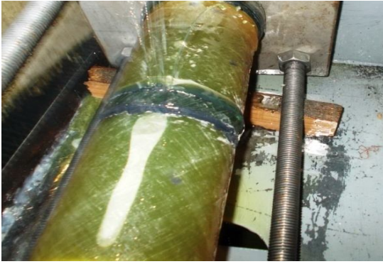
Şekil 4.24. DP 490 yapıştırıcı ile 20 mm yama kullanarak yapıştırılan 45^{\circ}/-45^{\circ}/45^{\circ}/-45^{\circ} oryantasyon açılı tabakalı kompozit boruların hasar durumları
