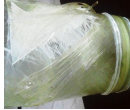
Şekil 4.33. DP 410 yapıştırıcı ile 40 mm yama kullanılarak yapıştırılan 55^{\circ}/-55^{\circ}/30^{\circ} / -30^{\circ} oryantasyon açılı tabakalı kompozit boruların hasar durumları
