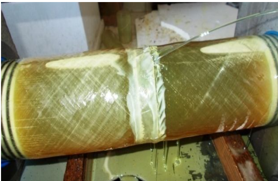
Şekil 4.43. DP 410 yapıştırıcı ile 15 mm bindirme uzunluğunda kademeli olarak yapıştırılan 45^{\circ}/-45^{\circ}/45^{\circ}/-45^{\circ} oryantasyon açılı tabakalı kompozit boruların hasar durumları
