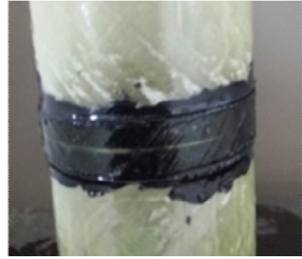
Şekil 4.24. DP 490 yapıştırıcı ile 20 mm yama kullanarak yapıştırılan 45^{\circ}/-45^{\circ}/45^{\circ}/-45^{\circ} oryantasyon açılı tabakalı kompozit boruların hasar durumları
