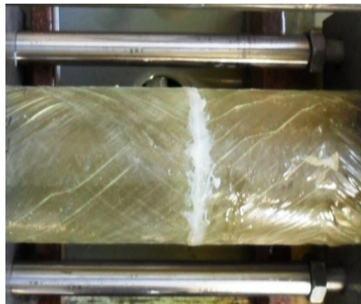
Şekil 4.19. DP 410 türü yapıştırıcı ile alın altına birleştirilmiş 55^{\circ}/-55^{\circ}/30^{\circ}/-30^{\circ} oryantasyon açılı tabakalı kompozit boruların hasar durumları
