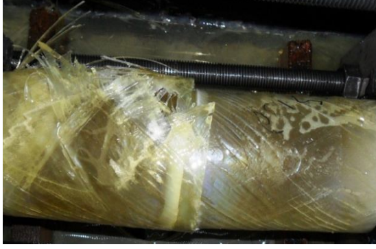
Şekil 4.47. DP 410 yapıştırıcı ile 10 mm bindirme uzunluğunda kademeli olarak yapıştırılan 55^{\circ}/-55^{\circ}/30^{\circ}/-30^{\circ} oryantasyon açılı tabakalı kompozit boruların hasar durumları
