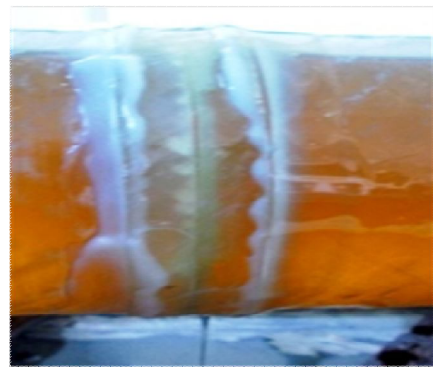
Şekil 4.25. DP 410 yapıştırıcı ile 30 mm yama kullanarak yapıştırılan 45^{\circ}/-45^{\circ}/45^{\circ}/-45^{\circ} oryantasyon açılı tabakalı kompozit boruların hasar durumları
