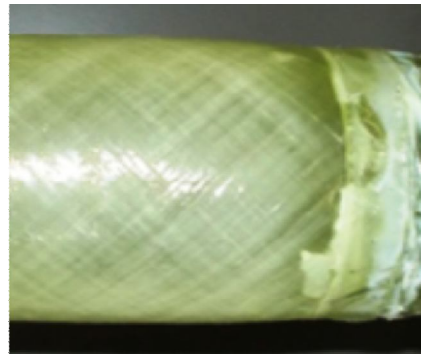
Şekil 4.43. DP 410 yapıştırıcı ile 15 mm bindirme uzunluğunda kademeli olarak yapıştırılan 45^{\circ}/-45^{\circ}/45^{\circ}/-45^{\circ} oryantasyon açılı tabakalı kompozit boruların hasar durumları
