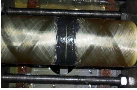
Şekil 4.38. DP 490 yapıştırıcı ile 30 mm yama kullanılarak yapıştırılan 55^{\circ}/-55^{\circ}/55^{\circ}/-55^{\circ} oryantasyon açılı tabakalı kompozit boruların hasar durumları
