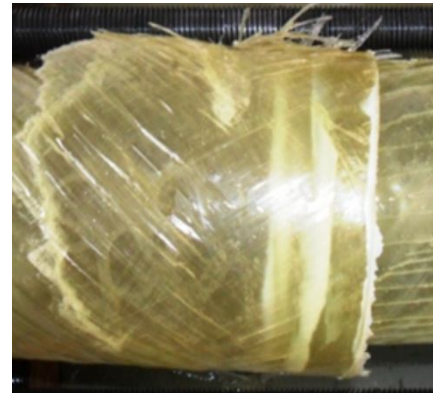
Şekil 4.49. DP 410 yapıştırıcı ile 15 mm bindirme uzunluğunda kademeli olarak yapıştırılan 55^{\circ}/-55^{\circ}/30^{\circ}/-30^{\circ} oryantasyon açılı tabakalı kompozit boruların hasar durumları
