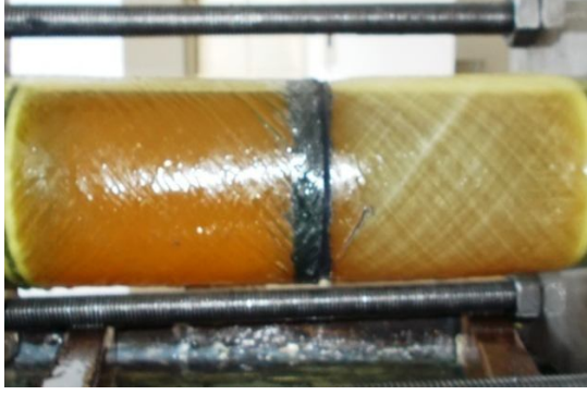
Şekil 4.44. DP 490 yapıştırıcı ile 15 mm bindirme uzunluğunda kademeli olarak yapıştırılan 45^0/-45^0/45^0/-45^0 oryantasyon açılı tabakalı kompozit boruların hasar durumları
