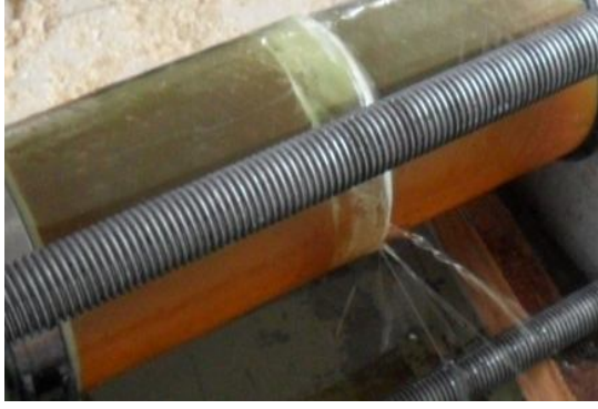
Şekil 4.57. DP 410 yapıştırıcı ile 20 mm bindirme uzunluğunda kademeli olarak yapıştırılan 55^0/-55^0/55^0/-55^0 oryantasyon açılı tabakalı kompozit boruların hasar durumları
