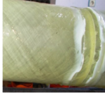
Şekil 4.23. DP 410 yapıştırıcı ile 20 mm yama kullanarak yapıştırılan 45^{\circ}/-45^{\circ}/45^{\circ}/-45^{\circ} oryantasyon açılı tabakalı kompozit boruların hasar durumları
