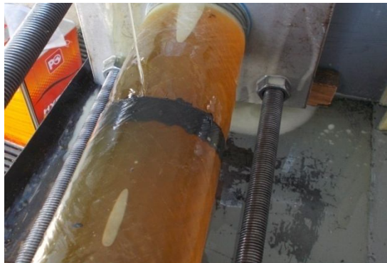
Şekil 4.46. DP 490 yapıştırıcı ile 20 mm bindirme uzunluğunda kademeli olarak yapıştırılan 45^0/-45^0/45^0/-45^0 oryantasyon açılı tabakalı kompozit boruların hasar durumları
