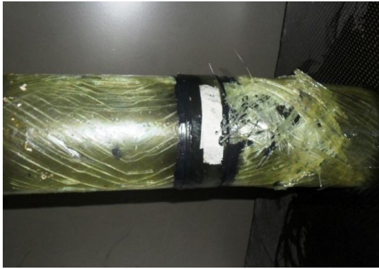
Şekil 4.34. DP 490 yapıştırıcı ile 40 mm yama kullanılarak yapıştırılan 55^{\circ}/-55^{\circ}/30^{\circ} / -30^{\circ} oryantasyon açılı tabakalı kompozit boruların hasar durumları
