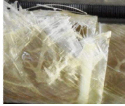
Şekil 4.47. DP 410 yapıştırıcı ile 10 mm bindirme uzunluğunda kademeli olarak yapıştırılan 55^{\circ}/-55^{\circ}/30^{\circ}/-30^{\circ} oryantasyon açılı tabakalı kompozit boruların hasar durumları
