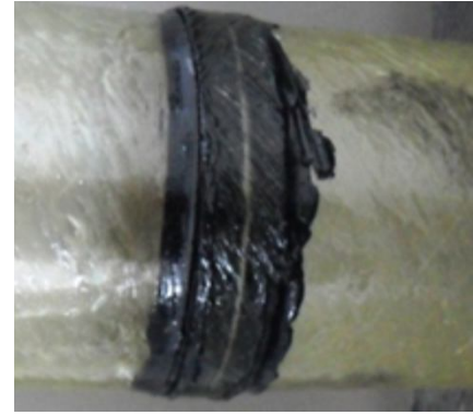
Şekil 4.36. DP 490 yapıştırıcı ile 20 mm yama kullanılarak yapıştırılan 55^{\circ}/-55^{\circ}/55^{\circ}/-55^{\circ} oryantasyon açılı tabakalı kompozit boruların hasar durumları
