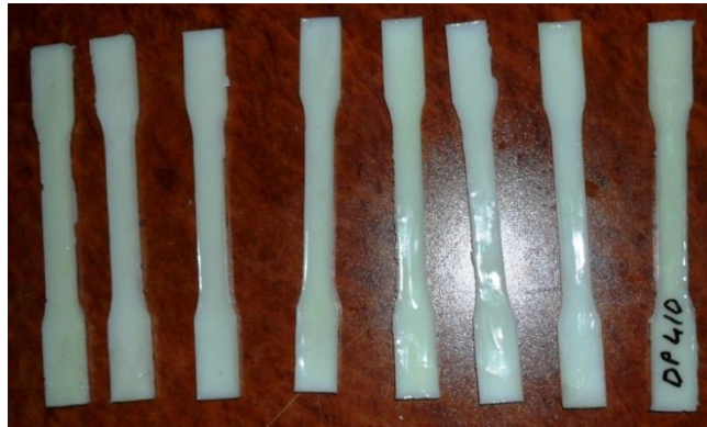
Şekil 3.18. DP 410 yapısal yapıştırıcı malzemelerin ISO 527-2 standardına uygun bulk model olarak dökülmüş numuneleri
