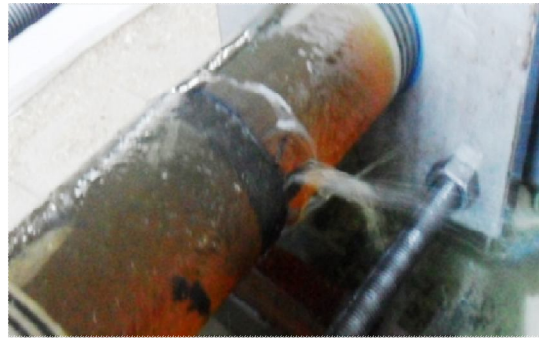
Şekil 4.58. DP 490 yapıştırıcı ile 20 mm bindirme uzunluğunda kademeli olarak yapıştırılan 55^0/-55^0/55^0/-55^0 oryantasyon açılı tabakalı kompozit boruların hasar durumları
