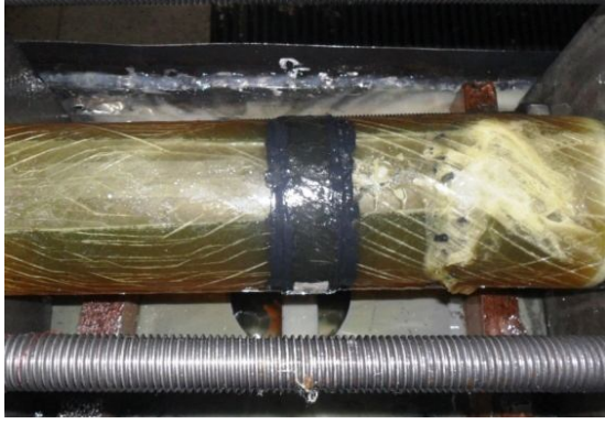
Şekil 4.32. DP 490 yapıştırıcı ile 30 mm yama kullanılarak yapıştırılan 55^{\circ}/-55^{\circ}/30^{\circ} / -30^{\circ} oryantasyon açılı tabakalı kompozit boruların hasar durumları
