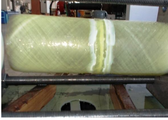
Şekil 4.23. DP 410 yapıştırıcı ile 20 mm yama kullanarak yapıştırılan 45^{\circ}/-45^{\circ}/45^{\circ}/-45^{\circ} oryantasyon açılı tabakalı kompozit boruların hasar durumları
