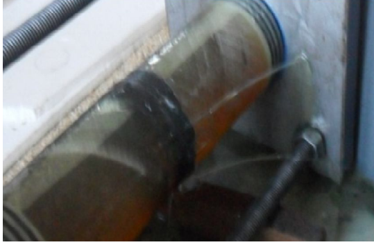
Şekil 4.56. DP 490 yapıştırıcı ile 15 mm bindirme uzunluğunda kademeli olarak yapıştırılan 55^0/-55^0/55^0/-55^0 oryantasyon açılı tabakalı kompozit boruların hasar durumları
