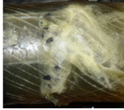
Şekil 4.32. DP 490 yapıştırıcı ile 30 mm yama kullanılarak yapıştırılan 55^{\circ}/-55^{\circ}/30^{\circ} / -30^{\circ} oryantasyon açılı tabakalı kompozit boruların hasar durumları
