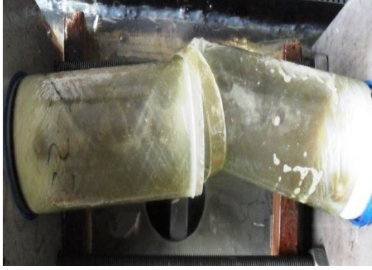
Şekil 4.35. DP 410 yapıştırıcı ile 20 mm yama kullanılarak yapıştırılan 55^{\circ}/-55^{\circ}/55^{\circ}/-55^{\circ} oryantasyon açılı tabakalı kompozit boruların hasar durumları
