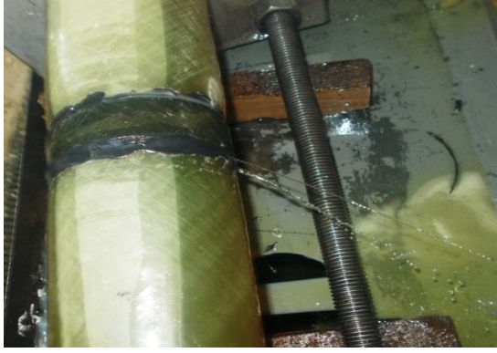
Şekil 4.26. DP 490 yapıştırıcı ile 30 mm yama kullanılarak yapıştırılan 45^{\circ}/-45^{\circ}/45^{\circ}/-45^{\circ} oryantasyon açılı tabakalı kompozit boruların hasar durumları
