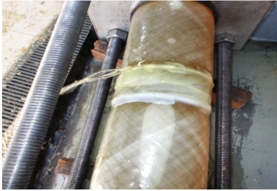
Şekil 4.27. DP 410 yapıştırıcı ile 40 mm yama kullanılarak yapıştırılan 45^{\circ}/-45^{\circ}/45^{\circ}/-45^{\circ} oryantasyon açılı tabakalı kompozit boruların hasar durumları
