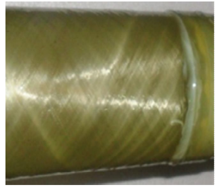
Şekil 4.37. DP 410 yapıştırıcı ile 30 mm yama kullanılarak yapıştırılan 55^{\circ}/-55^{\circ}/55^{\circ}/-55^{\circ} oryantasyon açılı tabakalı kompozit boruların hasar durumları
