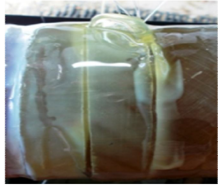
Şekil 4.27. DP 410 yapıştırıcı ile 40 mm yama kullanılarak yapıştırılan 45^{\circ}/-45^{\circ}/45^{\circ}/-45^{\circ} oryantasyon açılı tabakalı kompozit boruların hasar durumları
