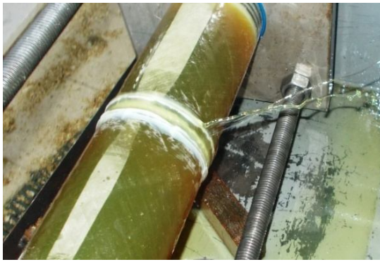
Şekil 4.25. DP 410 yapıştırıcı ile 30 mm yama kullanarak yapıştırılan 45^{\circ}/-45^{\circ}/45^{\circ}/-45^{\circ} oryantasyon açılı tabakalı kompozit boruların hasar durumları
