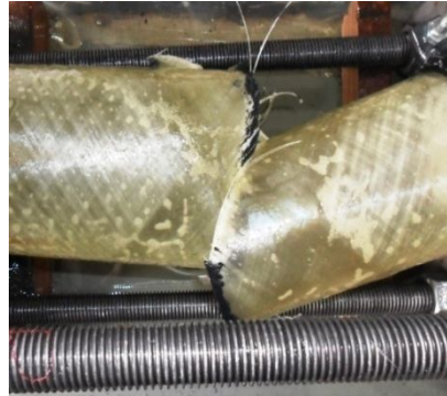
Şekil 4.22. DP 490 türü yapıştırıcı ile alın altına birleştirilmiş 55^{\circ}/-55^{\circ}/55^{\circ}/-55^{\circ} oryantasyon açılı tabakalı kompozit boruların hasar durumları
