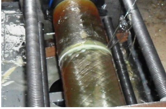
Şekil 4.53. DP 410 yapıştırıcı ile 10 mm bindirme uzunluğunda kademeli olarak yapıştırılan 55^0/-55^0/55^0/-55^0 oryantasyon açılı tabakalı kompozit boruların hasar durumları
