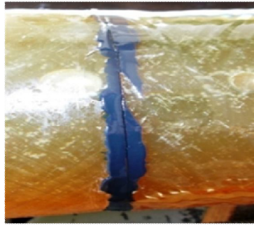
Şekil 4.18. DP 490 yapıştırıcı ile alın altına birleştirilmiş 45^{\circ}/-45^{\circ}/45^{\circ}/-45^{\circ} oryantasyon açılı tabakalı kompozit boruların hasar durumları
