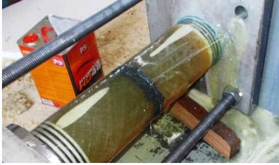
Şekil 4.42. DP 490 yapıştırıcı ile 10 mm bindirme uzunluğunda kademeli olarak yapıştırılan 45^{\circ}/-45^{\circ}/45^{\circ}/-45^{\circ} oryantasyon açılı tabakalı kompozit boruların hasar durumları
