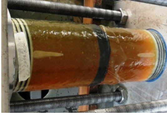
Şekil 4.50. DP 490 yapıştırıcı ile 15 mm bindirme uzunluğunda kademeli olarak yapıştırılan 55^0/-55^0/30^0/-30^0 oryantasyon açılı tabakalı kompozit boruların hasar durumları
