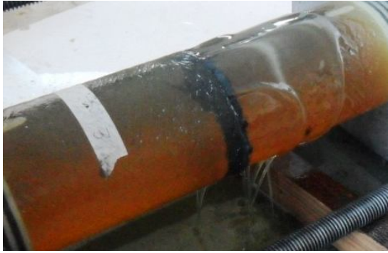
Şekil 4.54. DP 490 yapıştırıcı ile 10 mm bindirme uzunluğunda kademeli olarak yapıştırılan 55^0/-55^0/55^0/-55^0 oryantasyon açılı tabakalı kompozit boruların hasar durumları
