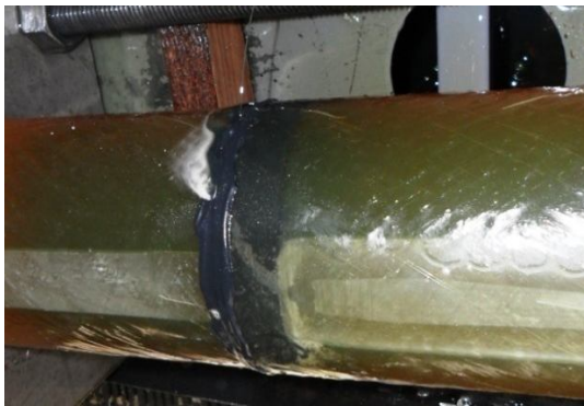
Şekil 4.52. DP 490 yapıştırıcı ile 20 mm bindirme uzunluğunda kademeli olarak yapıştırılan 55^0/-55^0/30^0/-30^0 oryantasyon açılı tabakalı kompozit boruların hasar durumları
