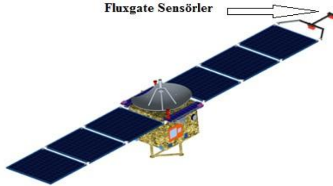
Şekil 2.45. YH-1 uydusu ve fluxgate sensörler [74]
