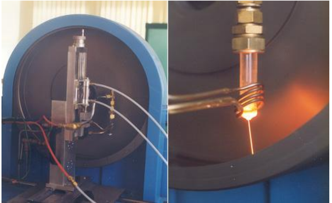
Şekil 2.5. In-rotating water-spinning yönteminin gösterimi [16]
