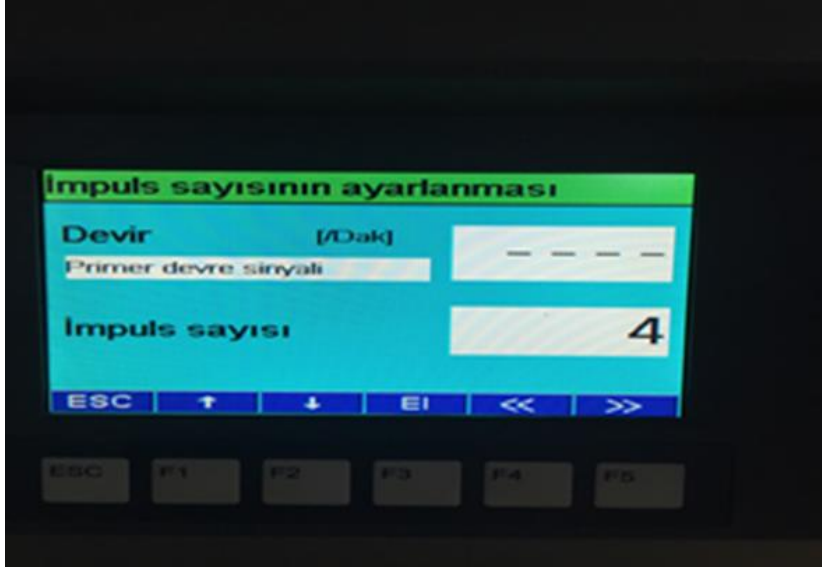
Şekil 3.19 : İmpuls sayısının ayarlanması.
