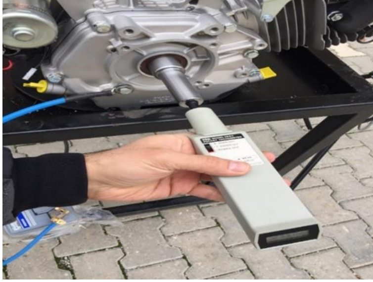
Şekil 3.23 : Takometre ile motor devir kontrolü.
