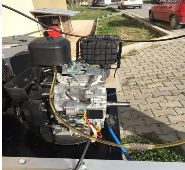
Şekil 4.23 : Yakıt hattına yerleştirilen mıknatısların görünümü
