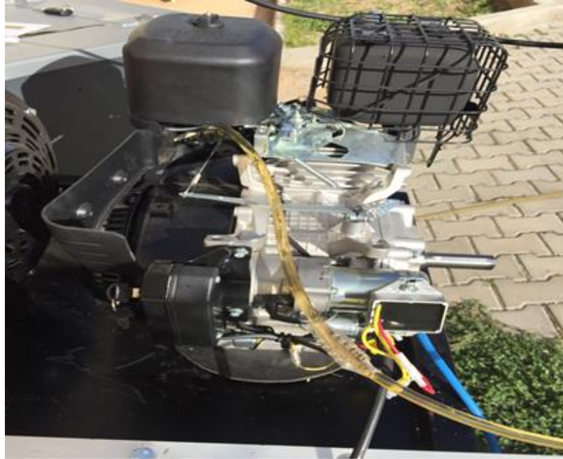
Şekil 4.14 : Yakıt hattına yerleştirilen mıknatısların görünümü.
