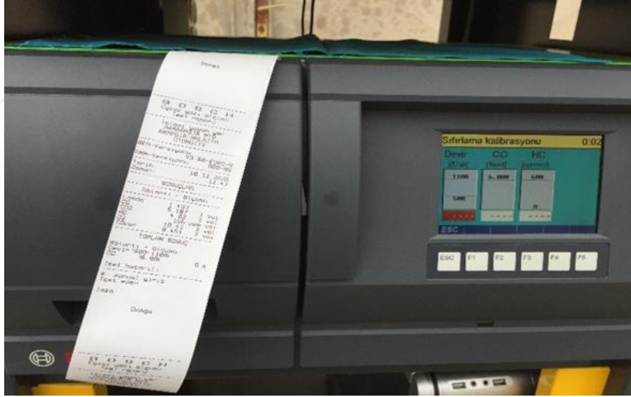
Şekil 3.22 : Egzoz emisyon gazı ölçüm değerleri çıktısı.
