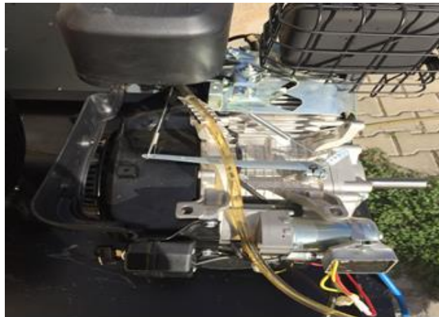
Şekil 4.6 : Yakıt hattına yerleştirilen mıknatısların gösterimi.
