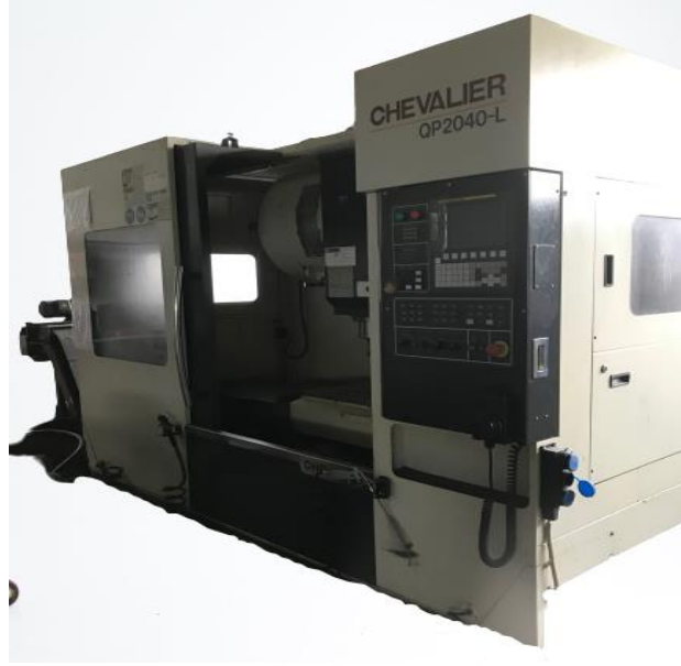
Şekil 4.5: Mikro frezelemede işleminin uygulandığı CHEVALIER QP 2040-L marka 3 eksenli CNC freze tezgâhı.
