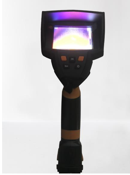
Şekil 4.11: TESTO 875-1 Kesme Sıcaklıklarını ölçen termal kamera.
