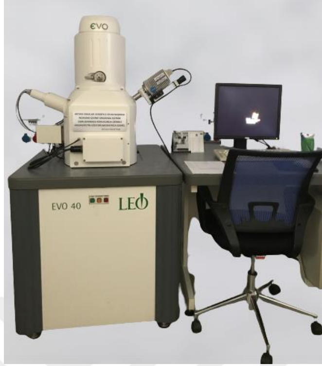
Şekil 4.8: Leo Evo-40xVP model taramalı elektron mikroskobu.
