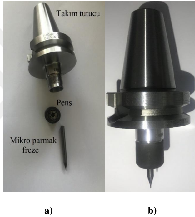
Şekil 4.6: a) Hassas tutucu pens ve parmak freze takımı b) montaj
