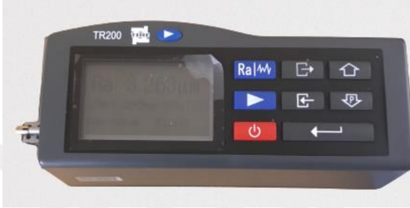
Şekil 4.10: TIME TR-200 yüzey pürüzlülük ölçüm cihazı.
