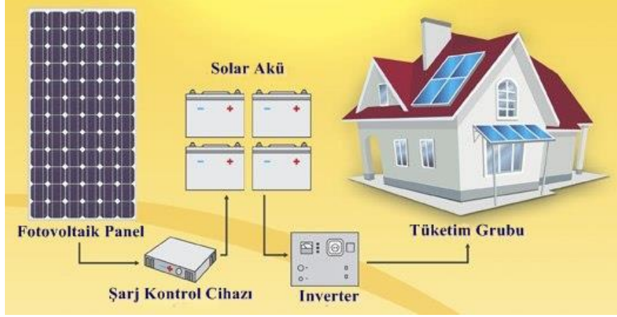
Şekil 3.16: Şebekeden bağımsız (off grid) FV santral bileşenleri genel yapısı [87]
