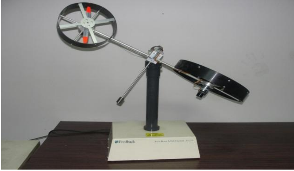
Şekil 4.1. TRMS (Twin Rotor MIMO System)
