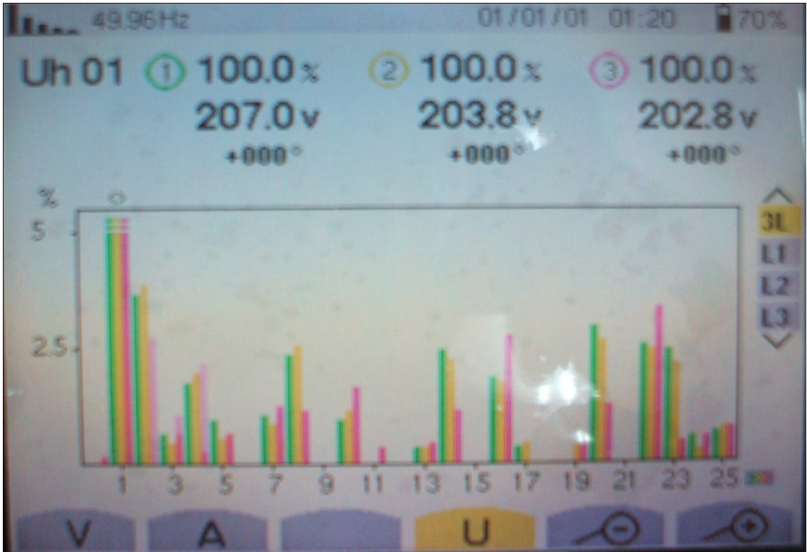
Şekil 4. 15. 50 Hz de üç fazın harmoniklerinin toplu ( her renk bir faz) görüntüsü
