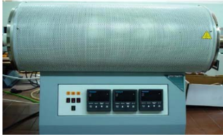
Şekil 4.48. Protherm PTF 12/60/700 model tüp fırın.
