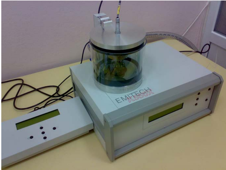
Şekil 3.11. Emitech K550X marka kaplama cihazının resmi.
