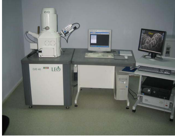
Şekil 3.13. Leo Evo-40xVP model elektron mikroskobu [107].
