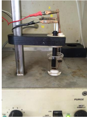
Şekil 3. 2. Voltametrik hücre ve montajı; A: Yardımcı Elektrot, W: Çalışma Elektrot, R: Referans Elektrot
