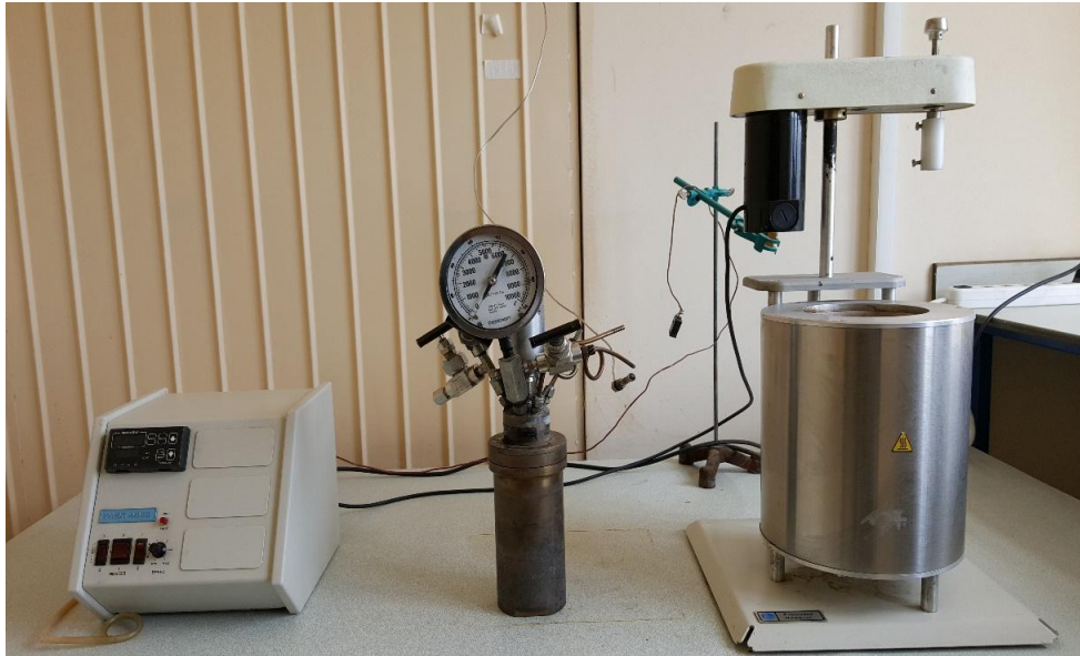
Şekil 3.3 Deneyde kullanılan kesikli reaktör sistemi
