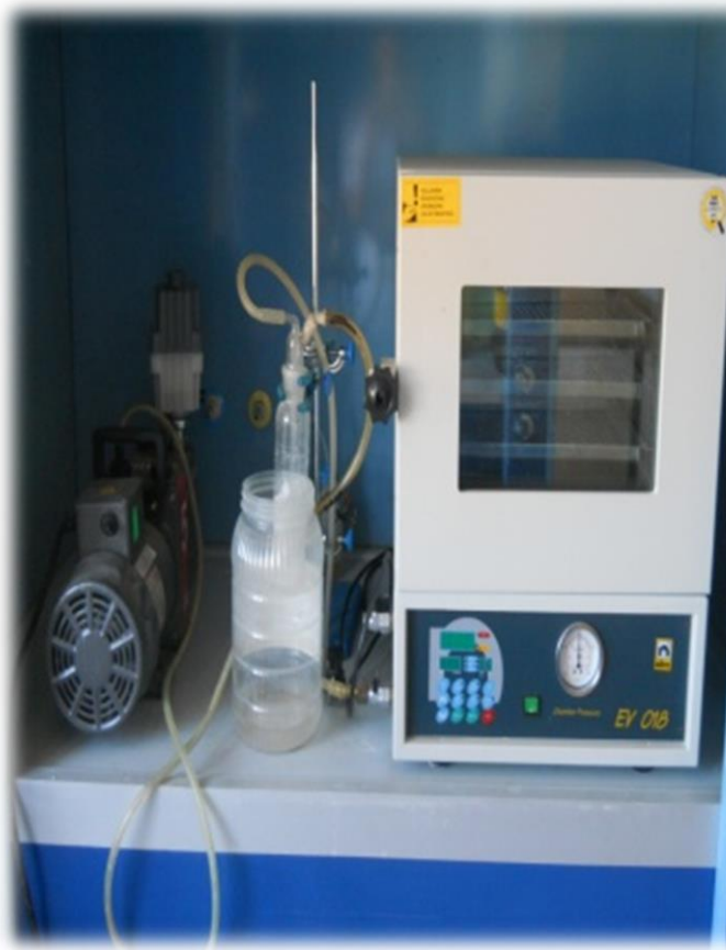
Şekil 3.6. (a) E.elaterium meyve suyunun kurutulduğu vakumlu fırın (b) kurutulan meyve suyu ve kalıntısı
