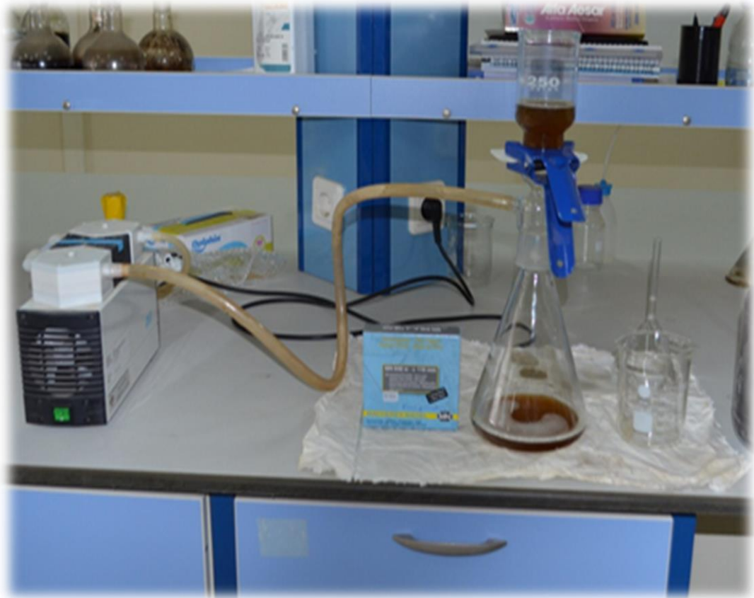
Şekil 3.5. E.elaterium meyve suyunun vakum düzeneği ile süzülmesi
