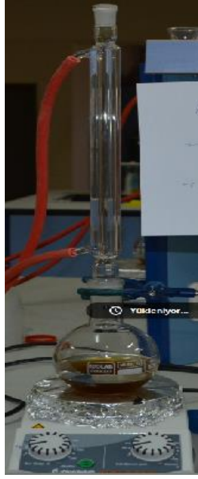
Şekil 3.8. E.elaterium meyve suyunun 40 °C sıcaklıkta dikey geri soğutucu kullanılarak hekzanla ekstraksiyonu
