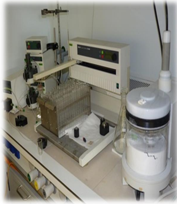
Şekil 3.13. E.elaterium kloroform ekstraktının flaş kromatografisinde fraksiyonlanması
