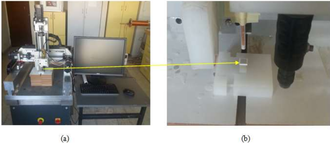
Şekil 4.35. (a) Üç boyutlu tarayıcı sistem ile periyodik oyuk açma işlemi (b) üzerine oyuk açılan plastik taban.
