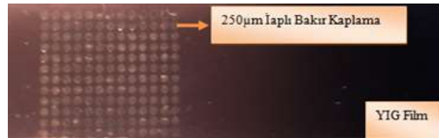
Şekil 3.9. 250µm çapında bakır YIG film üzerine litografi işlem uygulandıktan sonra elde edilen desenler.
