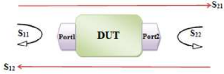
Şekil 3.13. S parametrelerinin şekilsel gösterimi.
