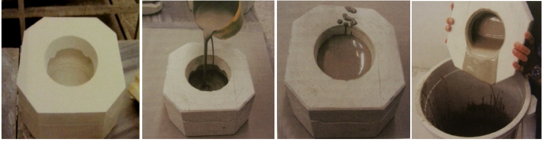
Fotoğraf 31: Döküm Yöntemiyle Şekillendirme Tekniği
