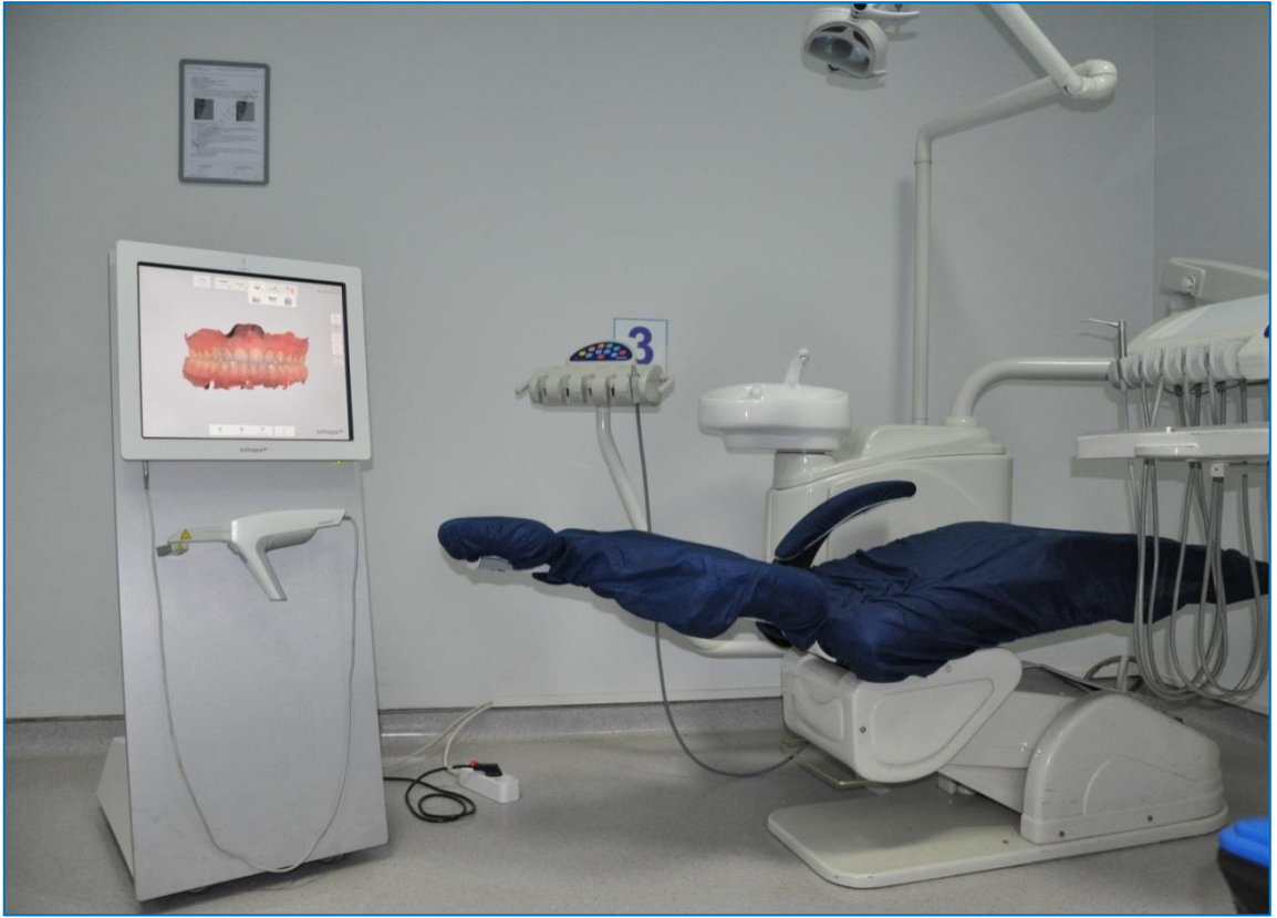
Şekil 3.4. 3B ağız içi tarayıcı (3Shape A/S, Copenhagen, Denmark)
