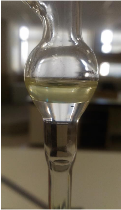
Şekil 3.6. Su destilasyonu yöntemiyle elde edilen nane uçucu yağı
