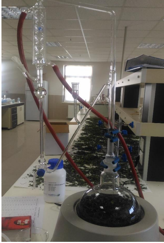
Şekil 3.5. Su destilasyonu deney düzeneği
