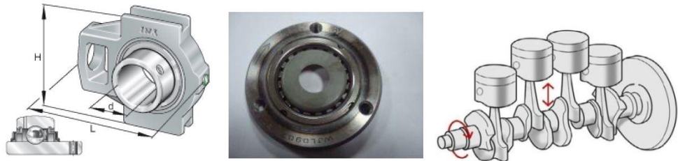
(a) rulmanlı yatak bileziği (b) kavrama göbeği (c) krank mili
