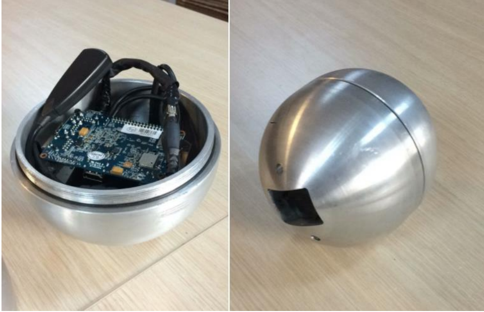
Şekil 2.14. Üretilen kaçak tespit robotu.
