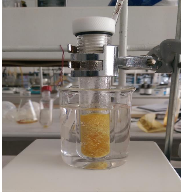
Şekil 4.2. Yüksek basınç tüpü içerisinde PEPPSI tipi NHC-Pd-piridin komplekslerinin sentezlenmesi
