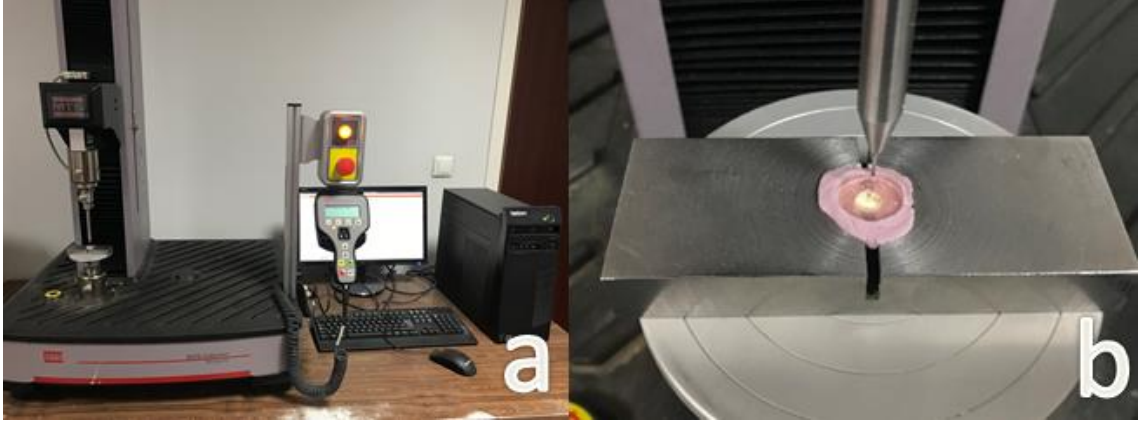
Şekil 3.10. a) İtme testinde kullanılan cihaz b) Kullanılan uç ve tabla
