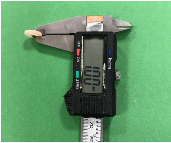
Şekil 3.9. Kesit yüksekliğinin dijital kumpas kullanılarak ölçülmesi
