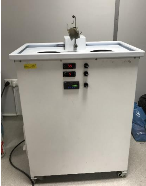
Şekil 3.11. Hidrotermal yaşlandırma işleminin yapılması
