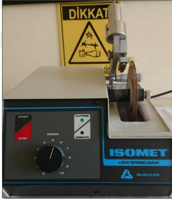
Şekil 3.17. Numunelerden push-out testi öncesi kesitler alınan Isomet 1000 cihaz
