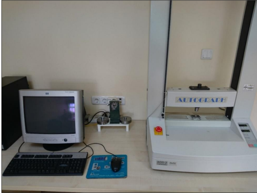
Şekil 3.19. Push-out testinin uygulandığı üniversal test cihazı
