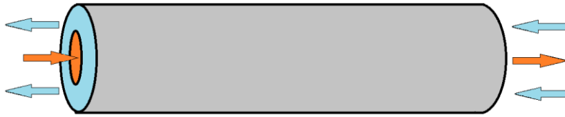
Şekil 2.5: Çift borulu ısı deęiřtiricisi örneđi
