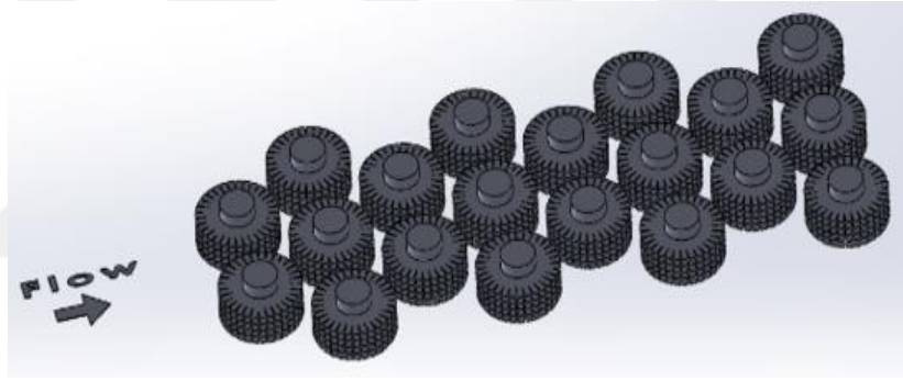
řekil 4.23: Kesikli dairesel kanatlı boru demeti
