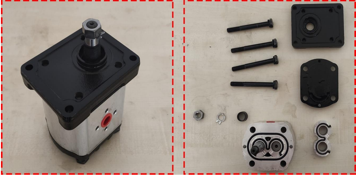
Şekil 3.3 : Referans alınan dıştan dişli pompa ve pompa elemanları.
