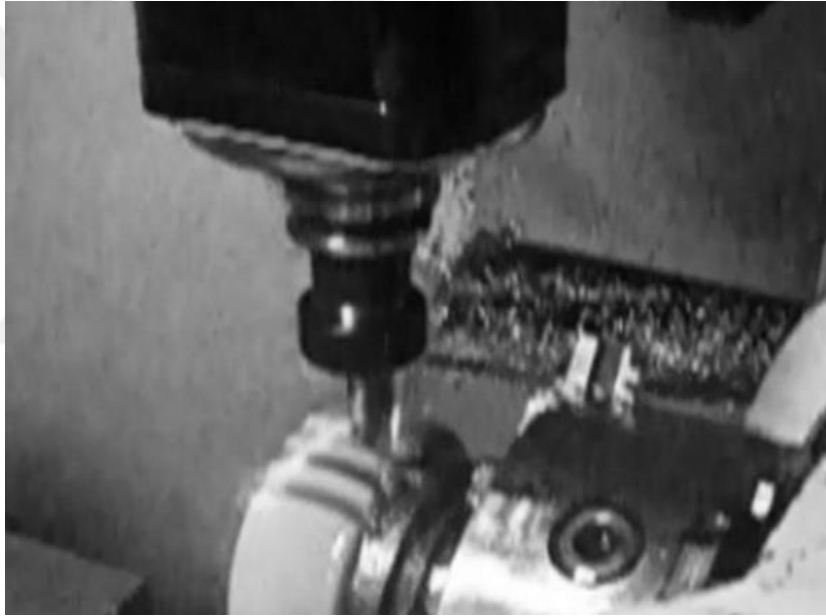
Şekil 2.14 : PEEK malzemedan üretilen eğrisel dişli çark [22].
