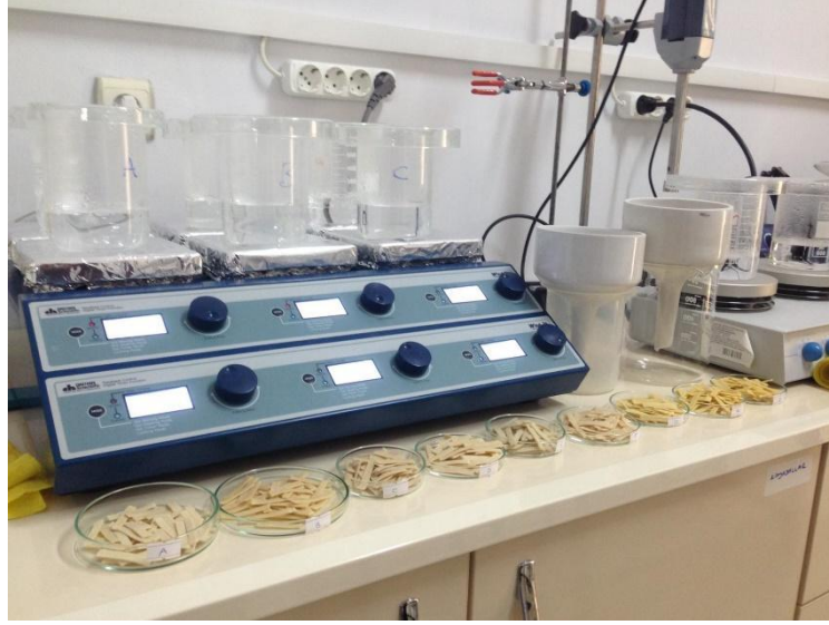
Şekil 4.4 : Eriştelerin pişme süresi tayininin yapıldığı düzenek.
