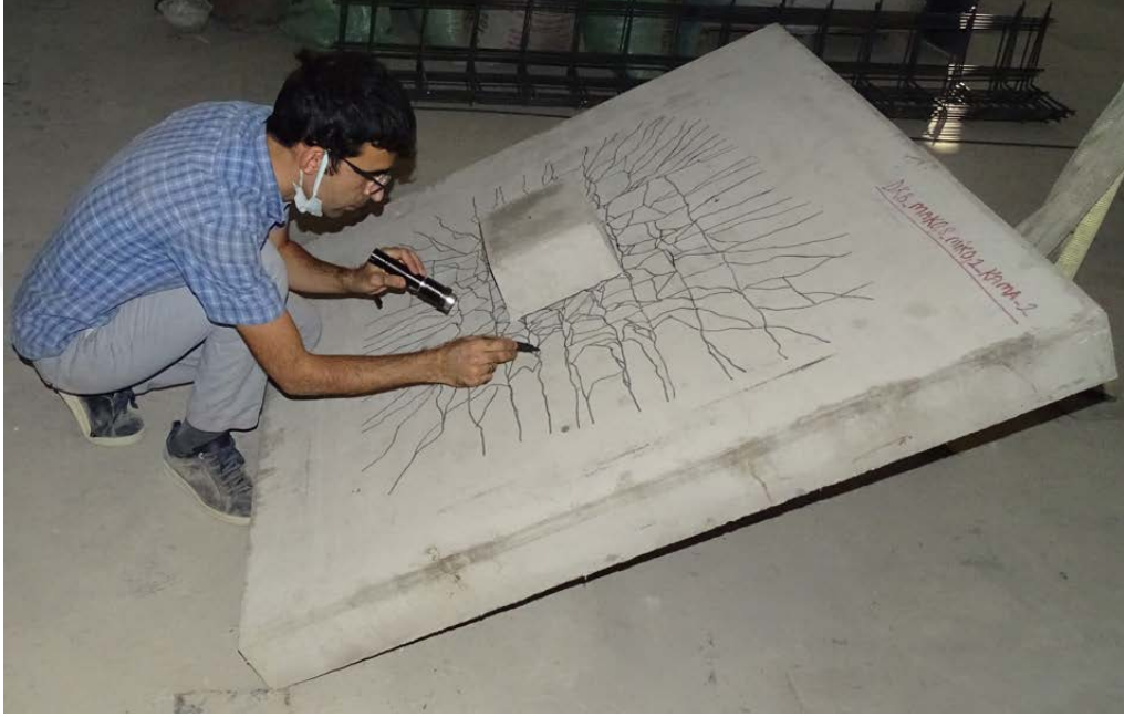
Şekil 3.21 : Döşeme-kolon birleşim elemanlarında test sonrası çatlakların belirginleştirilmesi.
