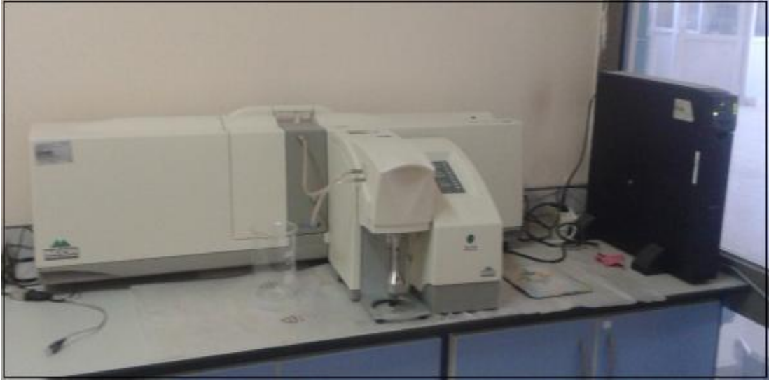
Şekil 3. 16 Mastersizer 2000 tane boyut analiz cihazı
