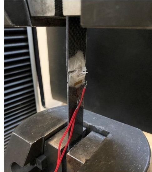
Strain gauge bağlanmış numunenin test sonrası hasarı
