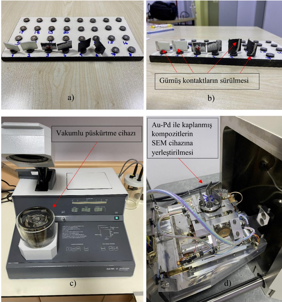
Şekil 3.38: Morfolojik analiz: a) Analiz numunelerinin hazırlanması, b) Gümüş kontakt işlemi, c) Altın-Paladyum kaplanması, d) Numunelerin SEM cihazına yerleştirilmesi.
