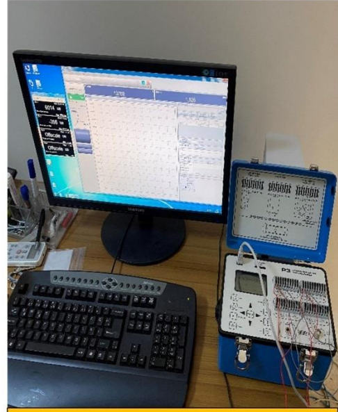
Strain gauge rozetlerinin gerinim ölçere bağlanması
