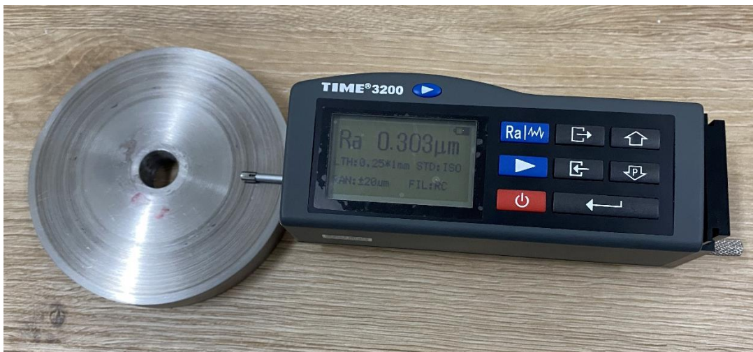
Şekil 3.34: Aşınmış disk yüzeyinin ortalama pürüzlülük değerinin belirlenmesi.
