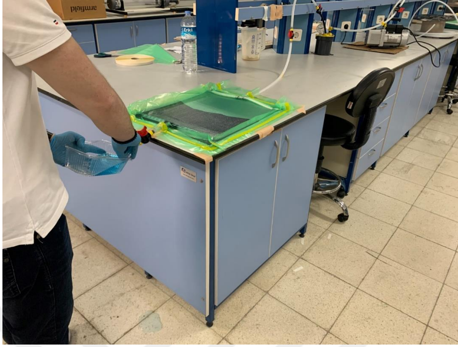
Şekil 3.4: VARTM deney düzeneğiyle kompozit plaka üretimi.
