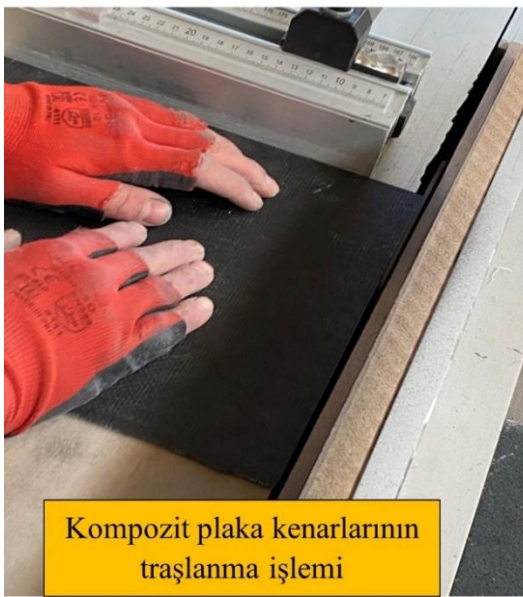
Şekil 3.7: Üretilen kompozit plakaların test numune geometrilerine göre kesilmesi.
