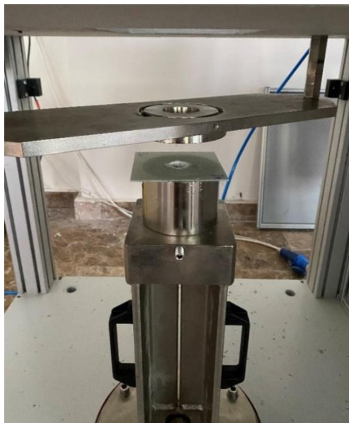
Şekil 3.26: Düşük hızlı darbe testi cihazında test edilmiş numunede oluşan delinme hasarı.
