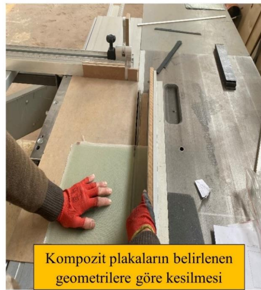
Şekil 3.7: Üretilen kompozit plakaların test numune geometrilerine göre kesilmesi.
