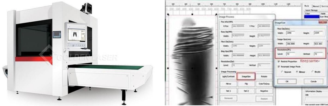
Şekil 1.2 : Lazer kazıma sistemi: (sol) Makine, (sağ) Yazılım [25].
