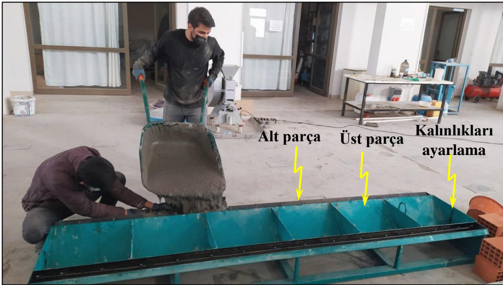
Şekil 3.17: V-şekilli betonarme katlanmış plakların beton dökümü
