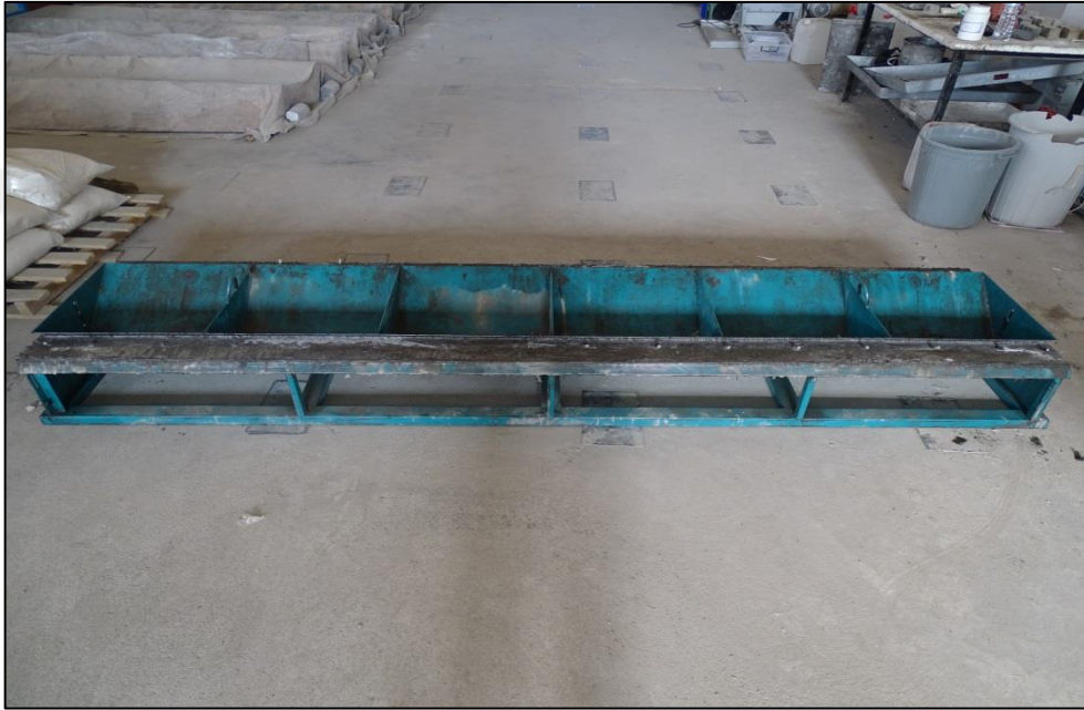
a) Kalıptan çıkarılacak V-şekilli betonarme katlanmış plak numune
