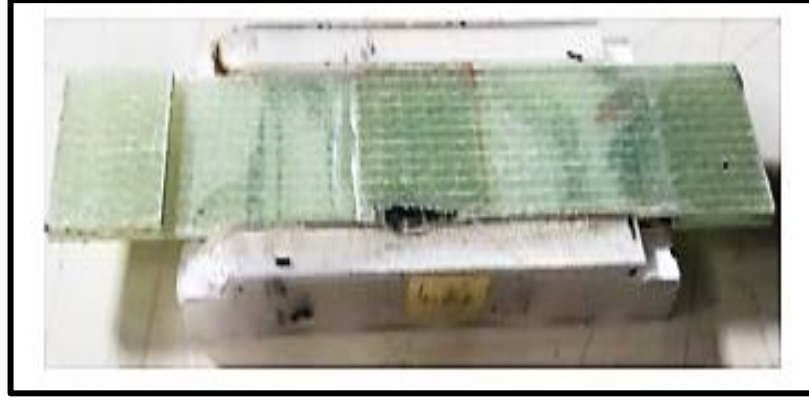
Şekil 2.9: Yapıştırıcı bağlantısının üretildiği kalıp [17].
