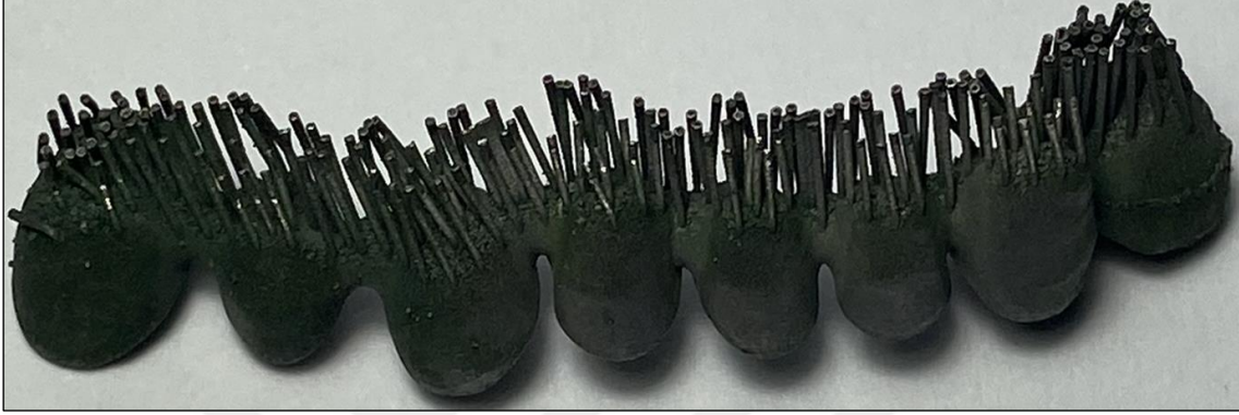
Şekil 5.7 : Metal eklemeli imalat sonrasında destek yapıların görüntüleri.
