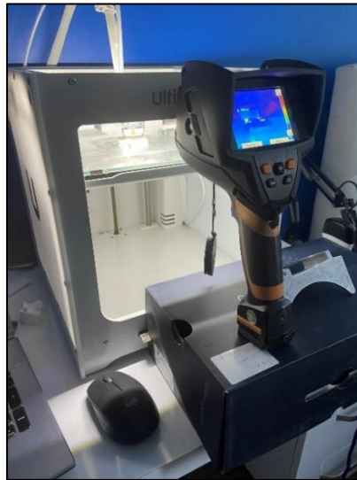
Şekil 4.9 : EYM yöntemi ile yapılan imalatlar sırasında termal görüntülerin alınması.
