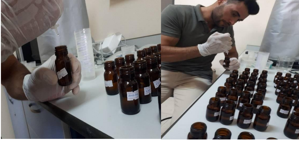
Şekil 3.7: Kaplardan sıvı örneklerin alınması ve süzülerek AAS analizlerine hazırlanması.
