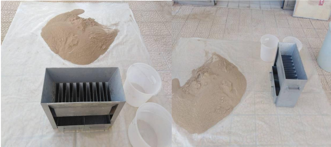
Şekil 3.2: Numunenin oluklu bölücüyle azaltılması
