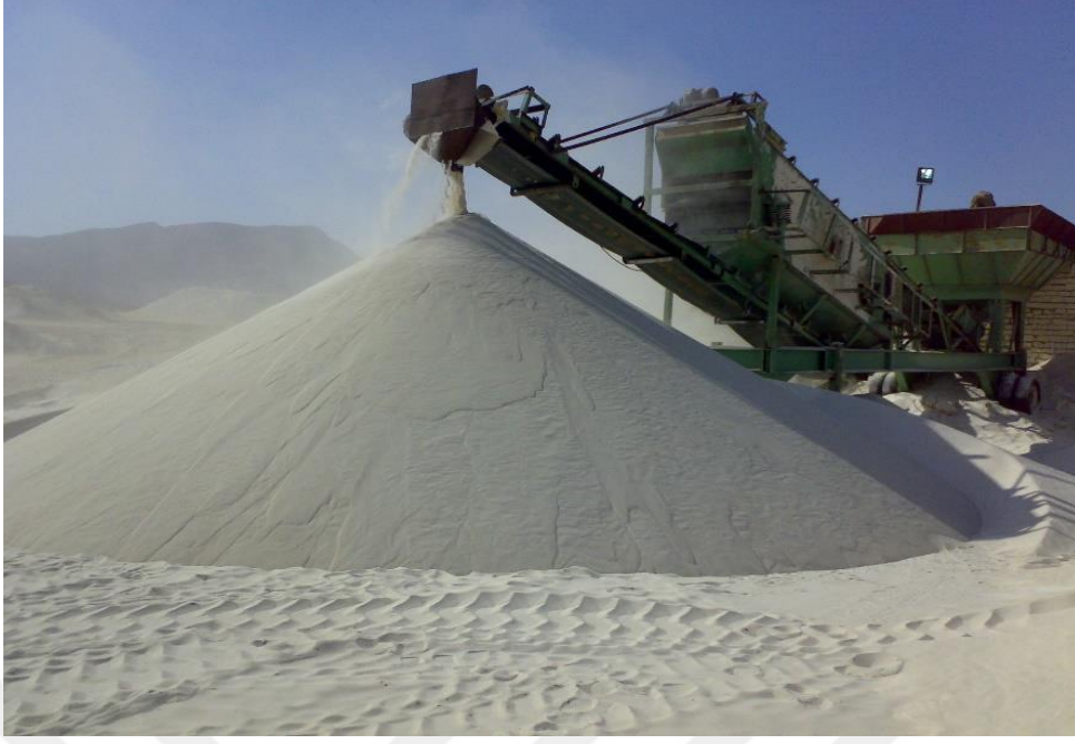
Şekil 2. 14: Mobil konkasörde kırılarak elde edilen kum.
