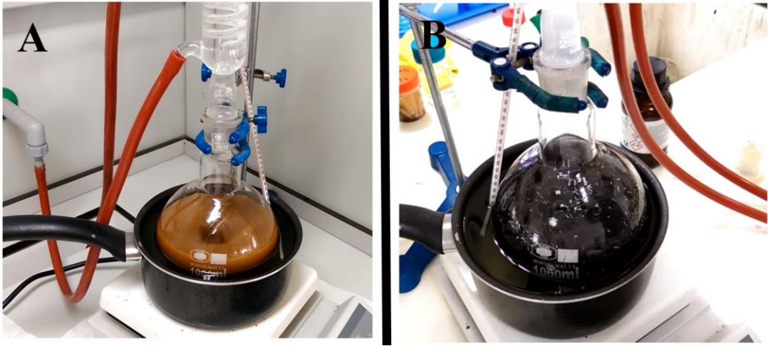
Şekil 3.1 : Grafen oksit (A) ve indirgenmiş grafen oksit (B) sentezi deney düzeneği
