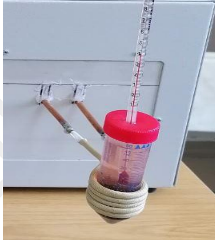
Şekil 4.15 : Bobine yerleştirilmiş ve içerisinde ferrojellerin ilaç salımı yaptığı tüp
