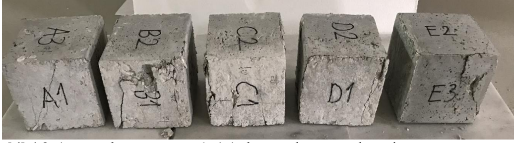
Şekil 4.9. 1.reçete beton numunelerinin basınç dayanımı deneyi sonrası görünümü.
