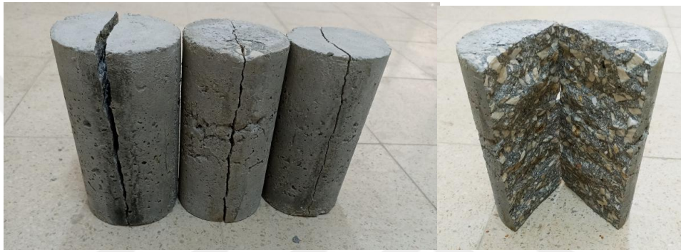
Şekil 4.13. 1. reçete beton numunelerinin yarmada çekme deneyi sonrası görünümü.
