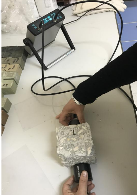
Şekil 4.25. Donma çözülme deneyi sonrası numunelere ultrasases geçirgenlik hızı deneyinin uygulanışı.
