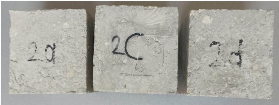
Şekil 4.22. 2. reçeteye ait numunelerin donma çözülme deneyi sonrası yüzey görünümleri
