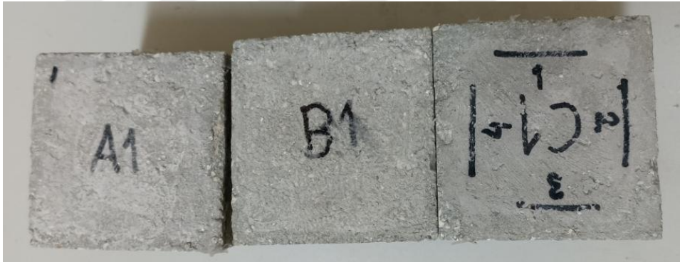
Şekil 4.21. 1. reçeteye ait numunelerin donma çözülme sonrası yüzey görünümleri
