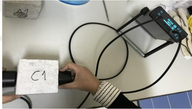
řekil 4.11. Ultrases geirgenlik hızı deney cihazı ve yapılıřı.
