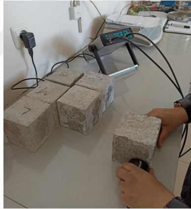
Şekil 4.31. Sülfat deneyi sonrası ultrases geçirgenlik hızı deneyinin yapılışı
