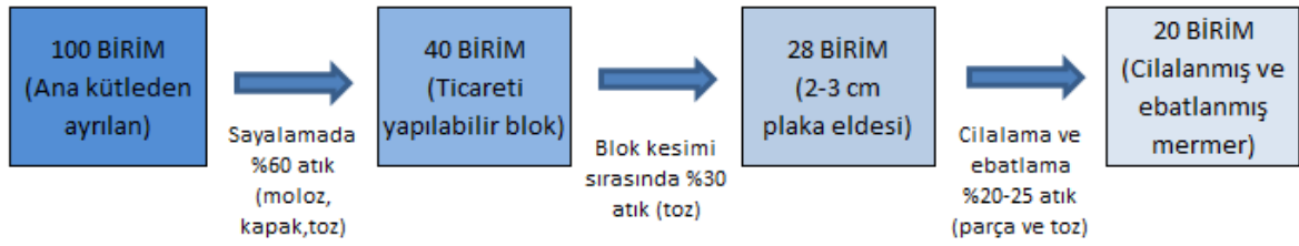
Şekil 2.2. Blok eldesinden cilalanmış mermer elde edilene kadar atık oluşumu.
