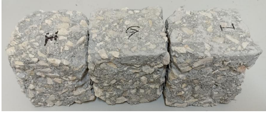
Şekil 4.19. 1. reçete numunelerinin buz çözücü tuz ile donma çözülme sonrası görünümleri.
