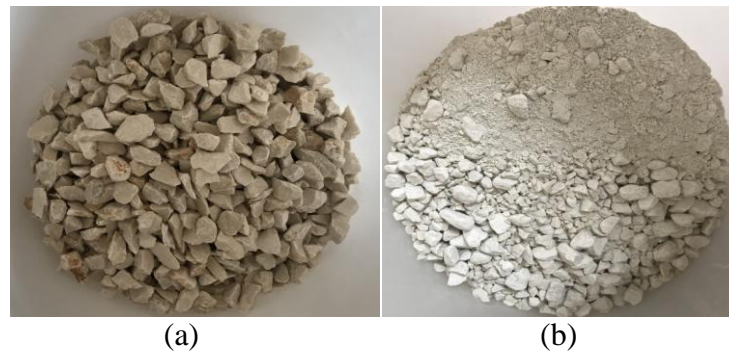
Şekil 4.4. a: Los Angeles deneyi öncesi numune görünümü, b: Deney sonrası numune görünümü.
