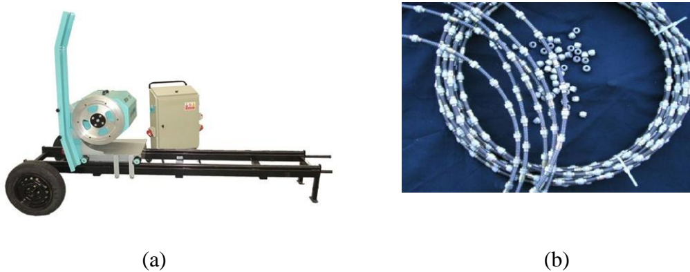
Şekil 2.8. a: Sayalama makinesi, b: Elmas tel.
