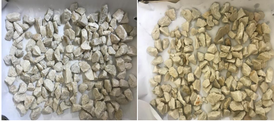
Şekil 4.8. Magnezyum Sülfat deneyi numune görünümleri (a: Deney öncesi numune görünümü, b: Deney sonrası numune görünümü)
