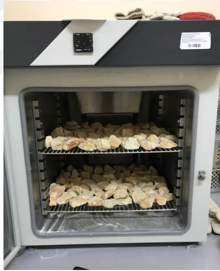
Şekil 3.8. Numunelerin boyut küçültme işleminden önce etüvde kurutulması.
