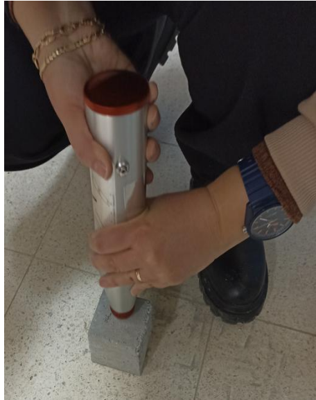
Şekil 4.12. Schmidt çekici ile sertlik deneyinin uygulanması.
