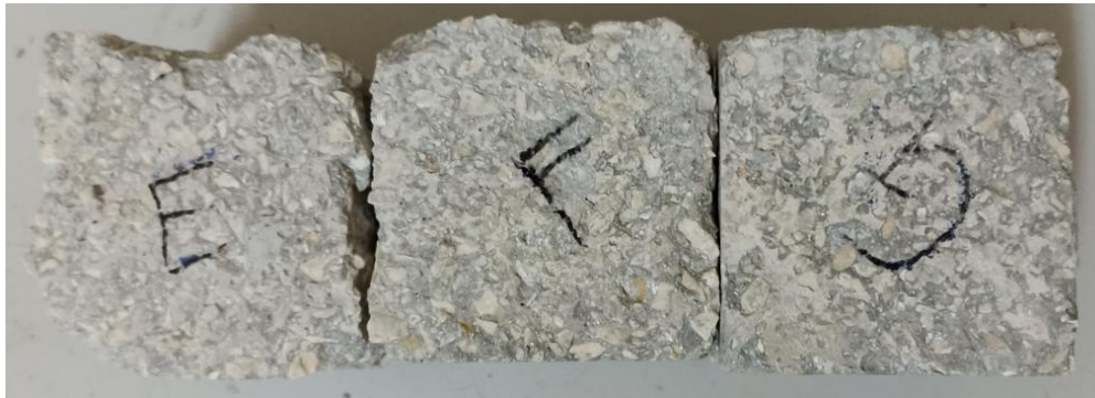
Şekil 4.18. 2. reçeteye ait numunelerin buz çözücü tuz ile donma çözülme sonrası yüzey görüntüleri
