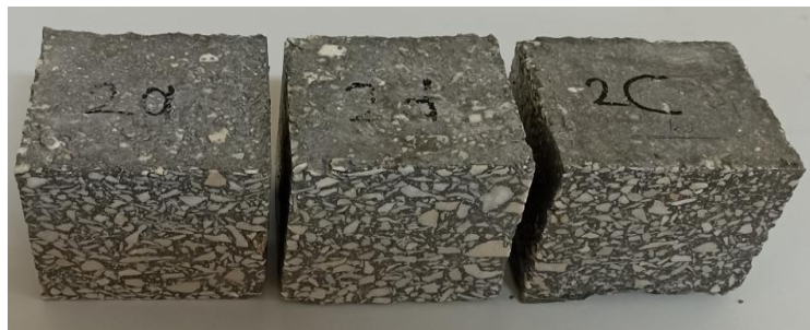
Şekil 4.24. 2. reçeteye ait numunelerin donma çözülme sonrası genel görünüşleri
