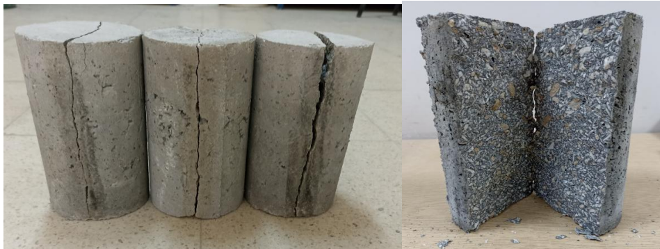
Şekil 4.14. 2. reçete beton numunelerinin yarmada çekme deneyi sonrası görünümü.
