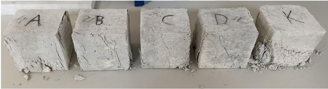
Şekil 4.10. 2. reçete beton numuneleri basınç dayanımı deneyi sonrası görünümü.
