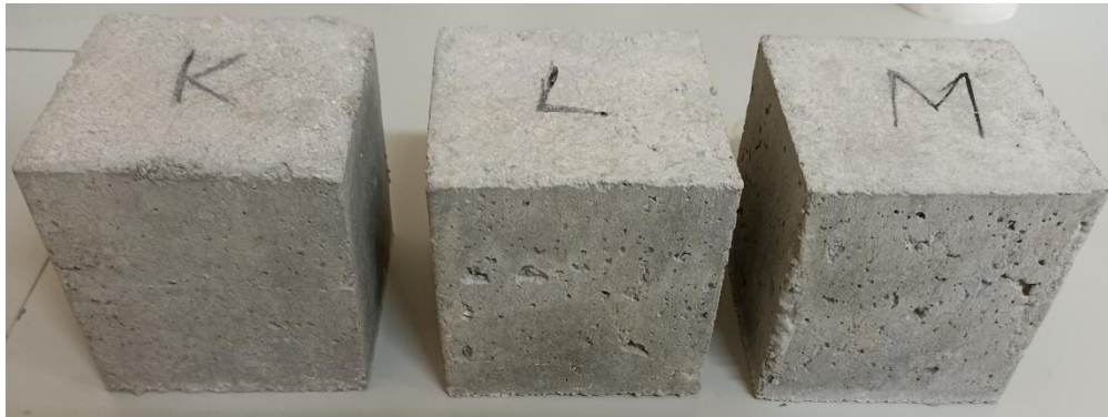
Şekil 4.26. 1. reçeteye ait numunelerin sülfat direnci deneyi sonrası görünüşleri
