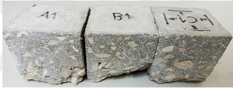
Şekil 4.23. 1. reçete numunelerinin donma çözülme sonrası genel görünüşleri
