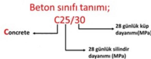
řekil 2.19. Beton sınıfı tanımı
