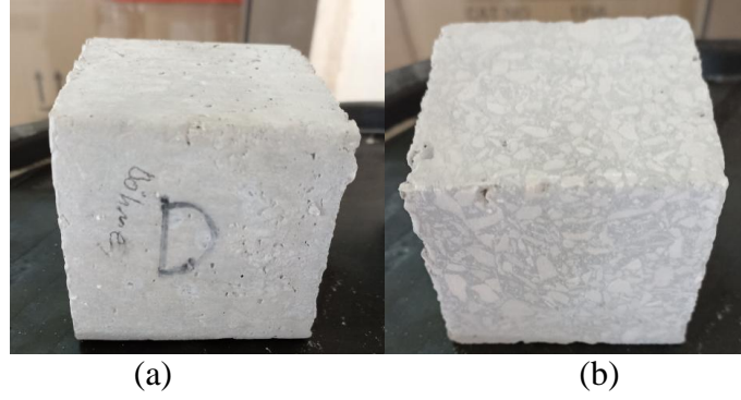
Şekil 4.16. 2. reçeteye ait bir numunenin Böhme aşınma dayanımı deneyi öncesi ve sonrası görünümleri. (a: Deney öncesi numune görünümü, b: Deney sonrası numune görünümü).
