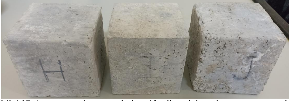
Şekil 4.27. 2. reçeteye ait numunelerin sülfat direnci deneyi sonrası görünüşleri.
