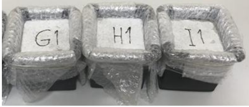
Şekil 3.29. Buz çözücü tuz ile donma çözülme deneyi için hazırlanmış numunelerin görünümü.
