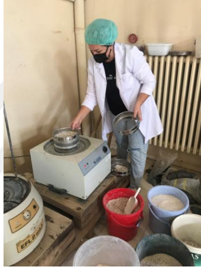
Şekil 3.10. Numunelerin elenmesi ve boyutlarına göre sınıflandırılması.
