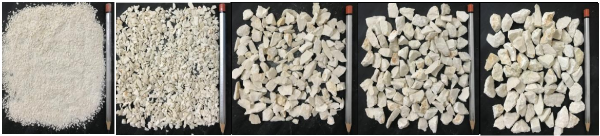
Şekil 3.11. Sırasıyla 0-2 mm, 2-4,75 mm, 4,75-9,5 mm, 9,5-11,2 mm, 11,2-14 mm boyutları arasında sınıflandırılmış numunelerin görünümü.
