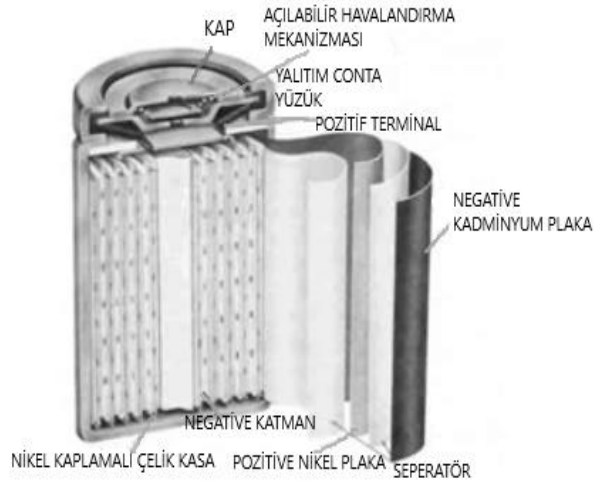
Şekil-1.9 Nikel Kadmiyum pilin yapısı [29].
