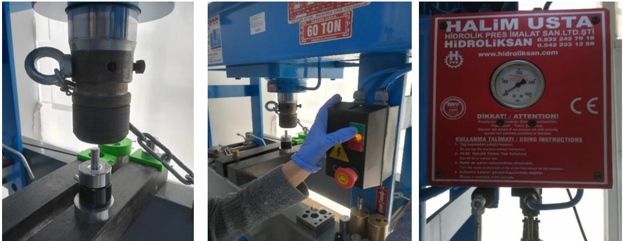
Şekil-2.2. Hazırlanan \text{Na}_{0.67}(\text{Mn}_{0.5}\text{Fe}_{0.5})_{1-x}\text{Co}_x\text{O}_2 numunesinin tablet haline getirilmesi.
