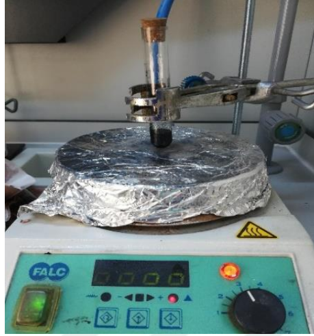
Şekil-2.4.1 PVDF +NMP+ Carbon Black ile katot malzemesinin çamur haline getirilmesi.
