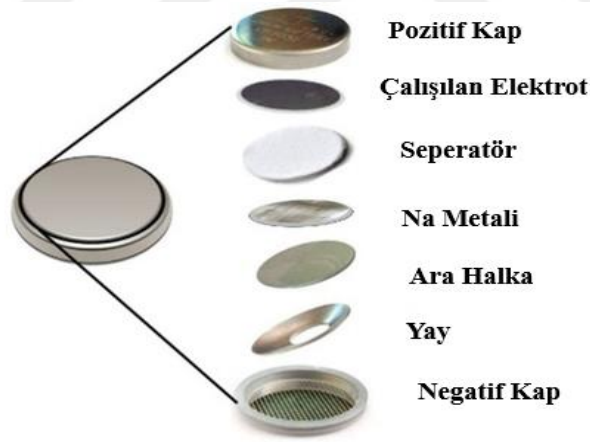
Şekil-2.4.6 CR2032 tipi pil birleştirme sıralaması [138].
