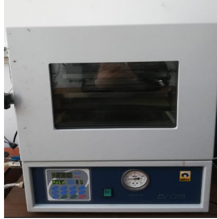
Şekil-2.4.3 Kaplanan alüminyum folyonun vakumlu etüvde kurutulması.
