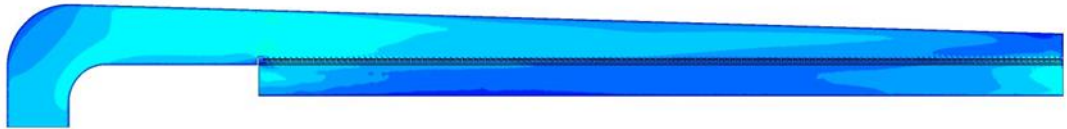
Şekil 5.14 : Porozitenin B_5= 0.4 olduğu durumdaki hız konturları.
