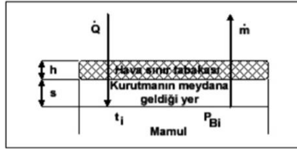
Şekil 3.8 : Mamul yüzeyi ile kurutma gazı arası kütle ve ısı transferi- 2. Aşama
