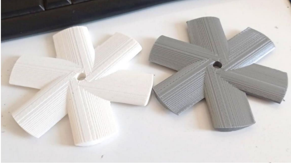
Şekil 5.5: Çalışmada kullanılacak 3D yazıcıdan çıktısı alınmış Wells Türbini
