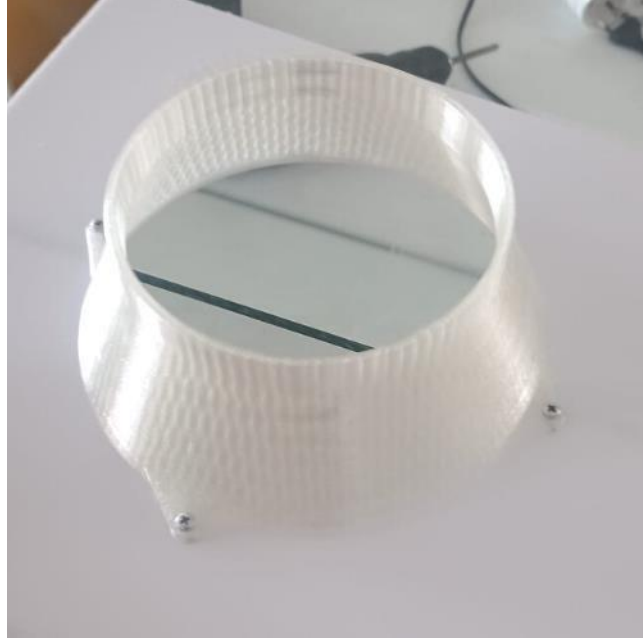
Şekil 5.32: Konik yapının 3 boyutlu yazıcıdan üretimi ve monteli halinin görünümü
