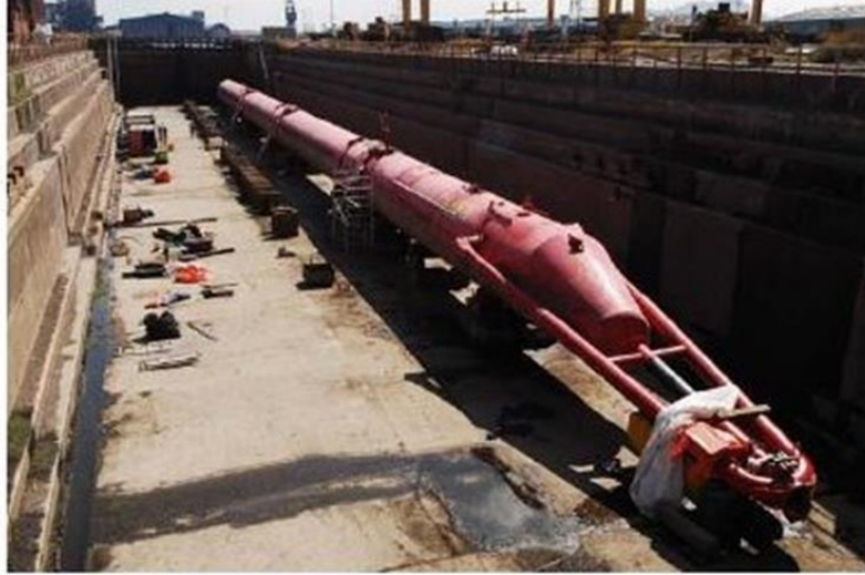
Şekil 3.24: Tam ölçekli Pelamis prototipinin donanım değişikliği için alındığı kuru havuzdaki görüntüsü [36].
