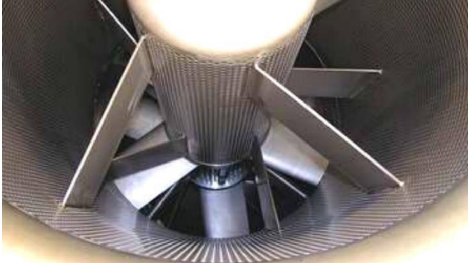
Şekil 5.3: Pilot tesiste kullanılan Wells Türbini [73]
