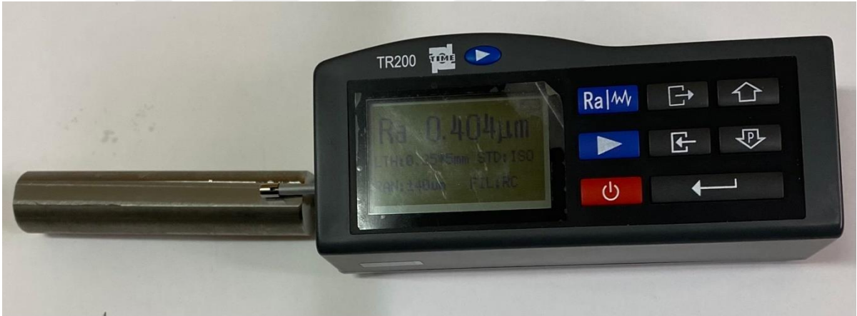
Şekil 4.3: Frezelenme İşleminde Yüzey Pürüzlülük Ölçümü
