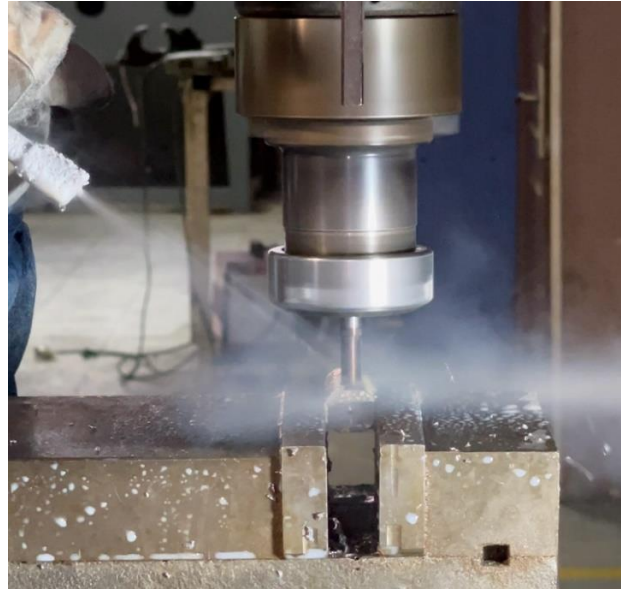
Şekil 4.7: Hibrit işleme yöntemi ile Ti6Al4V alaşımının işlenmesi
