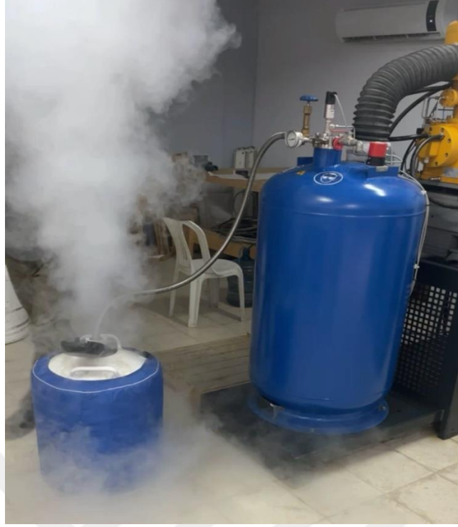
Şekil 4.6: Kriyojenik soğutma için kullanılan Lowtemp marka sıvı azot tankı
