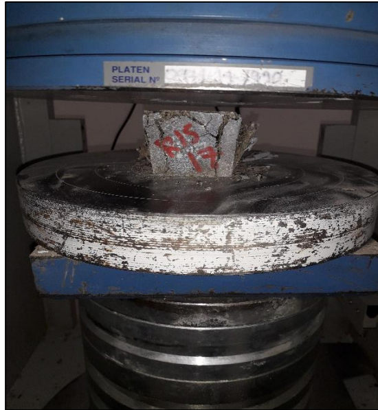
Şekil 3.18 : Basınç dayanım cihazındaki beton numune.
