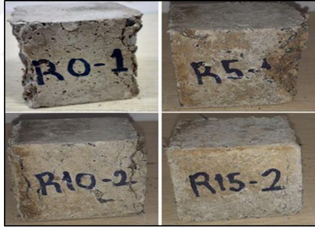
Şekil 4.5 : Kür süresini tamamlayan kontrol numunelerinin basınç dayanım deneyi sonrası görünüşleri.
