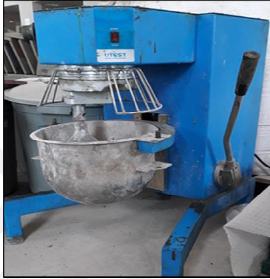
Şekil 3.8 : Beton karışım mikseri.
