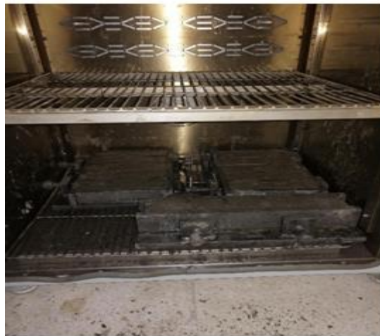
Şekil 4.19: Kullanılan numunelerin etüve bırakılması.
