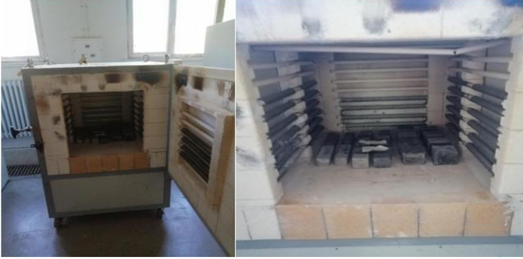
Şekil 4.24 : Yüksek sıcaklık fırını ve yüksek sıcaklık fırınına numunelerin yerleştirilmesi.
