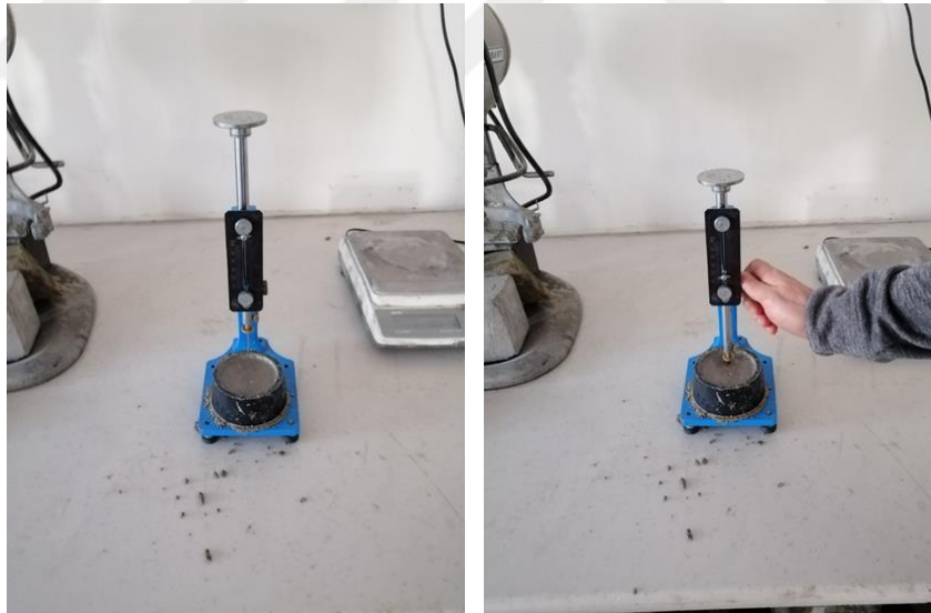
Şekil 4.20: Vicat aleti kullanılarak priz süresinin belirlenmesi
